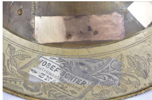
Obr. 33 Výsledek čištění po 10 min redukci
