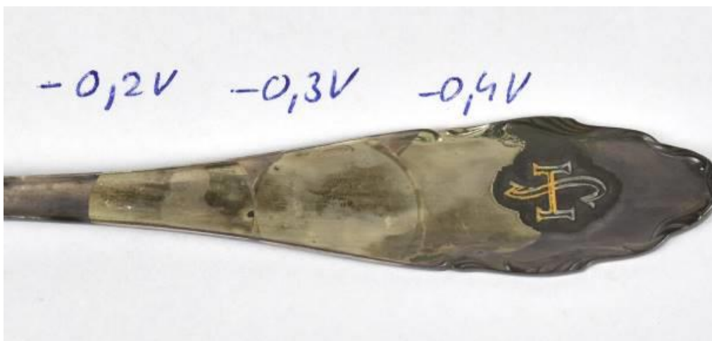
Obr. 25 Ukázka čištění chloridové vrstvy na čistém stříbře (elektrolyt: 1% Na 3 H(CO 3 ) 2 )
