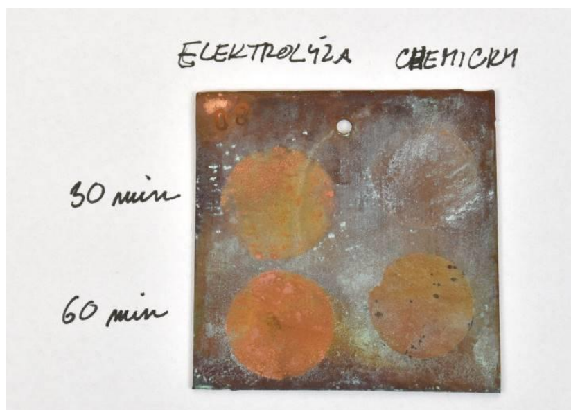
Obr. 39 Porovnání vlivu polarizace při použití citrátu amonného jako elektrolytu
