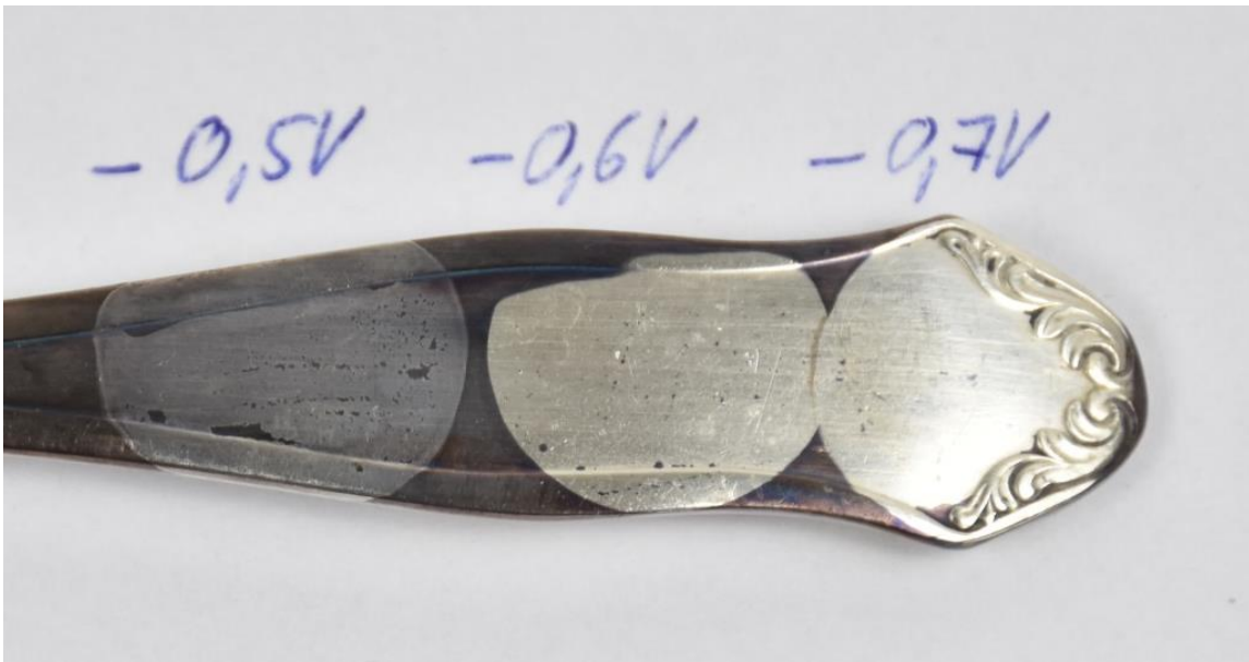
Obr. 22 Ukázka čištění sulfidové vrstvy na čistém stříbře (elektrolyt: 1% citrátový pufr)
