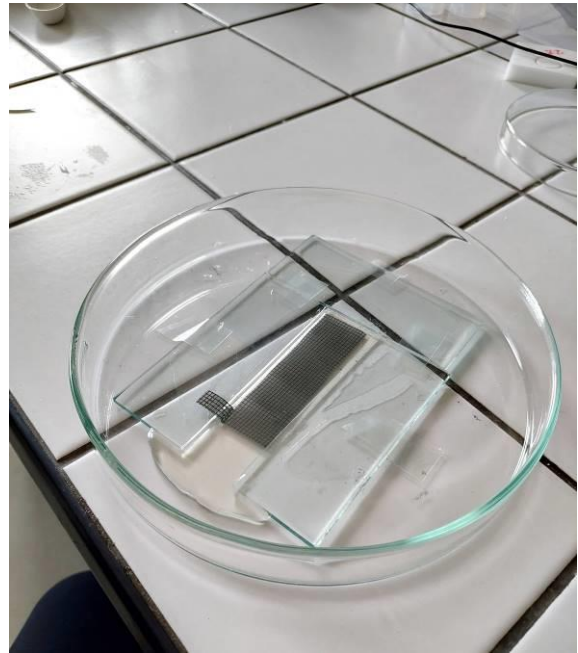
Obr. 5 Zalévání sítky gelovým elektrolytem
