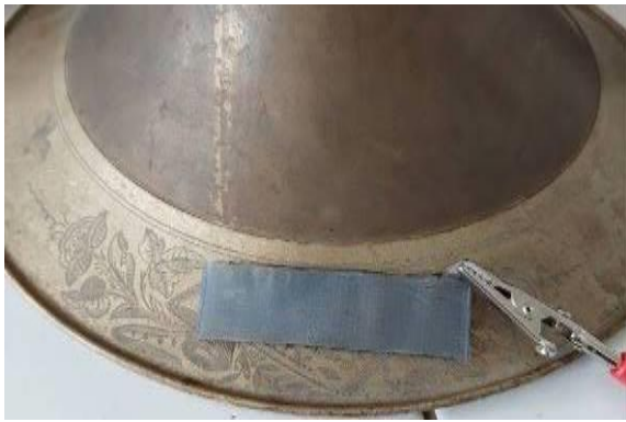
Obr. 30 Aplikace gelu ve formě sendviče
