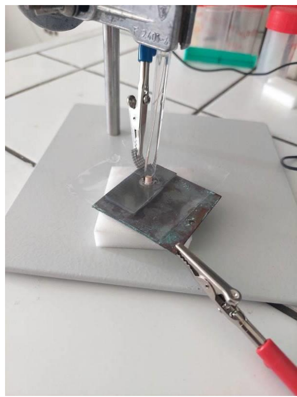
Obr. 7 Redukce na povrchu mědi pomocí kovové sítky s vrstvou gelového elektrolytu
