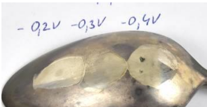
Obr. 26 Ukázka čištění chloridové vrstvy na čistém stříbře (elektrolyt: 1% citrátový pufr)
