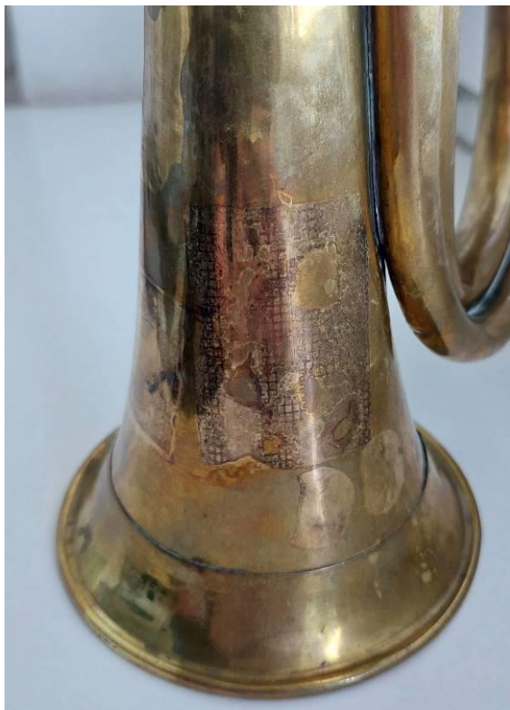
Obr. 6 Nežádoucí otištění sítky na povrchu
