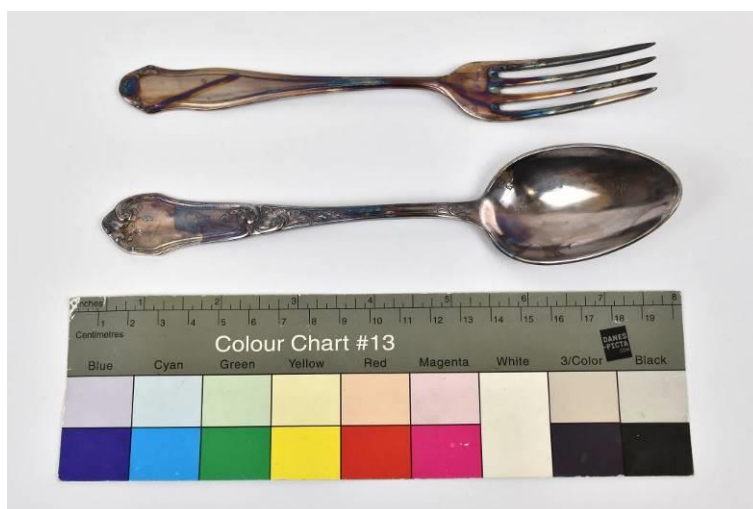
Obr. 10 Vzorky postříbřených příborů s umělou sulfidickou vrstvou
