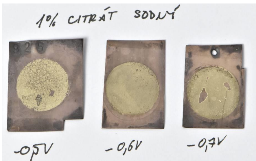
Obr. 28 Ukázka čištění chloridové vrstvy na šterlinkovém stříbře (elektrolyt: 1% citrát sodný) 3
