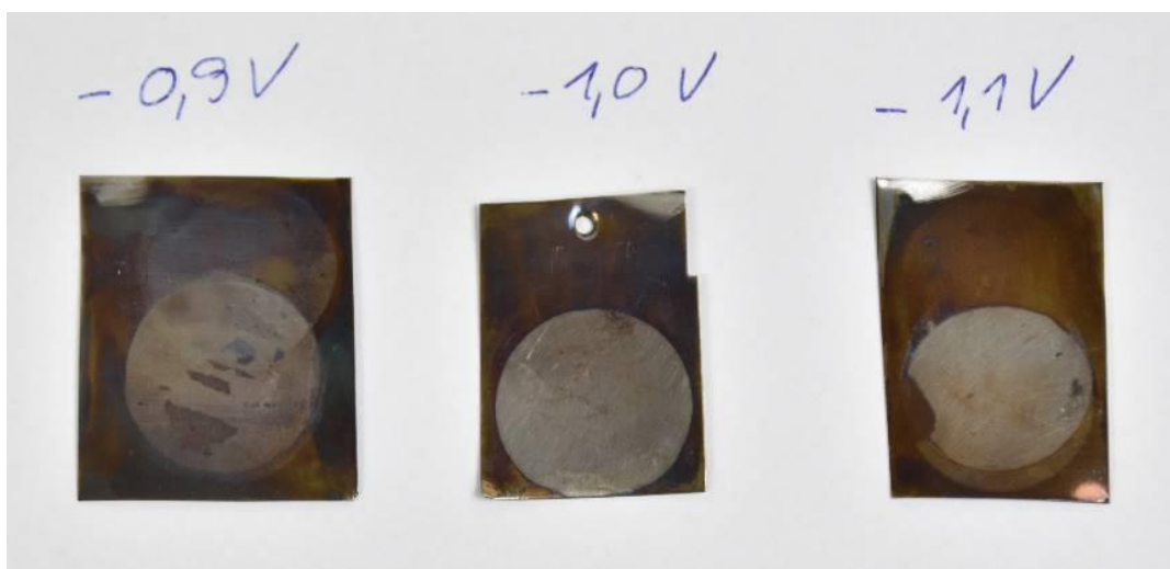
Obr. 23 Ukázka čištění sulfidové vrstvy na šterlinkovém stříbře (elektrolyt: 1% Na 3 H(CO 3 ) 2 )
