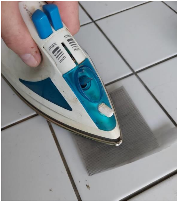
Obr. 4 Nažehlování plastové sítky na kovovou sítku
