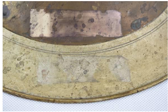
Obr. 31 Výsledek čištění po 2 min redukci 4
