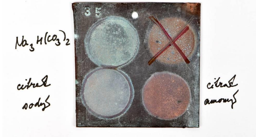
Obr. 35 Vliv elektrolytů na čištění síranové korozní vrstvy při -1,0 V
