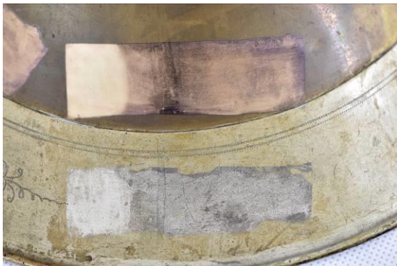
Obr. 32 Výsledek čištění po 5 min redukci
