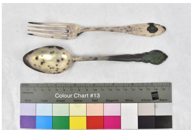
Obr. 12 Vzorky postříbřených příborů s umělou chloridovou vrstvou
