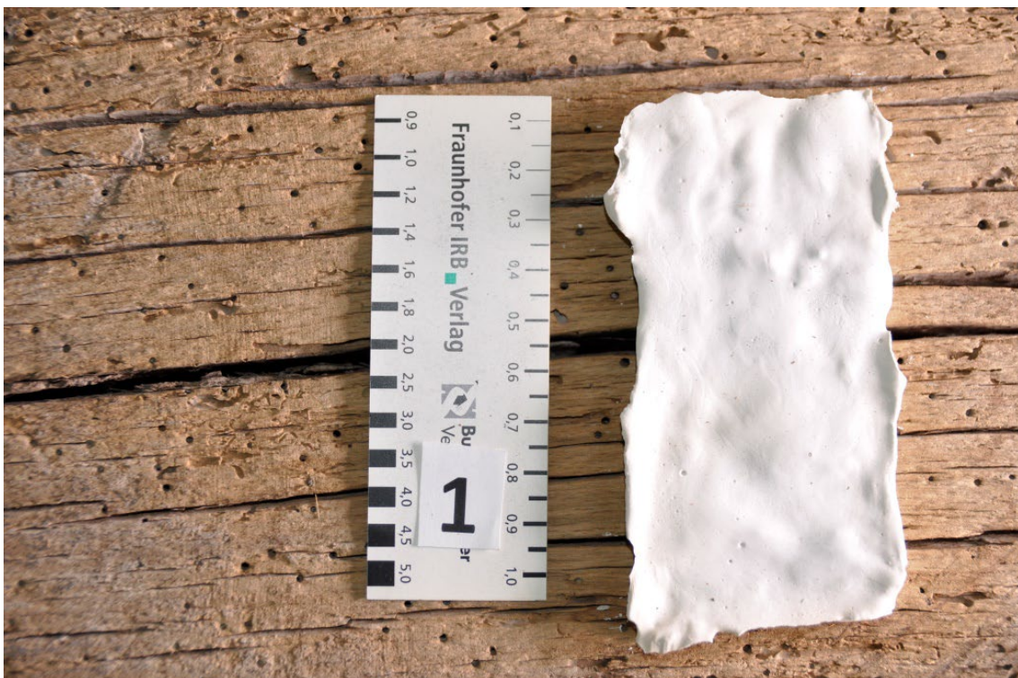
Obr. 19 Vzorek č. 1 se sádrovým terčikem na podélné ploše po druhém ošetření
