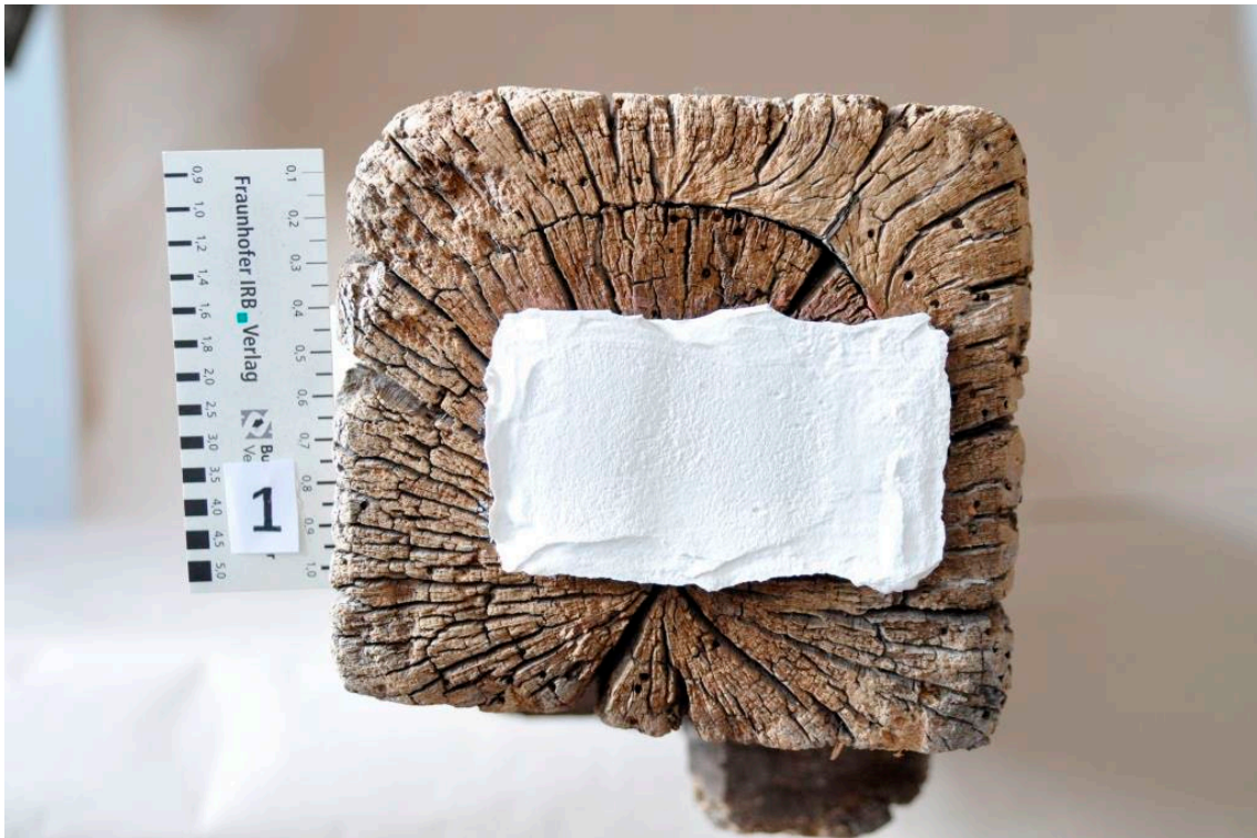
Obr. 20 Vzorek č. 1 se sádrovým terčíkem na příčné ploše před ošetřením
