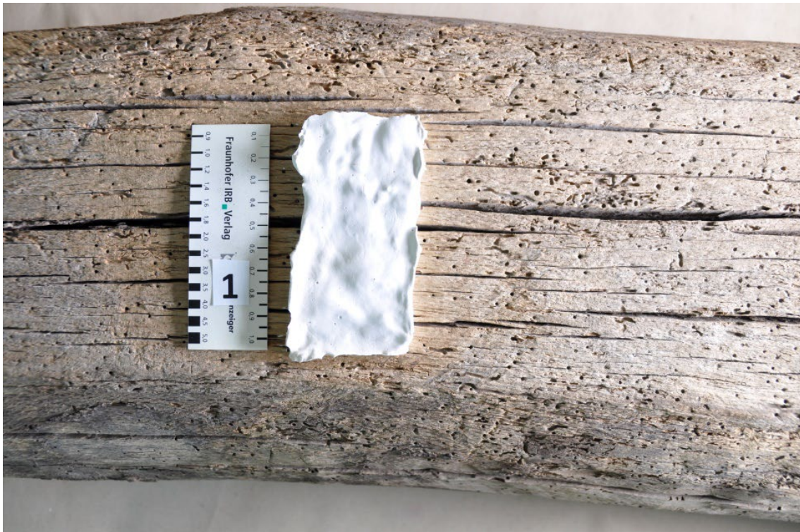
Obr. 18 Vzorek č. 1 se sádrovým terčikem na podélné ploše před ošetřením
