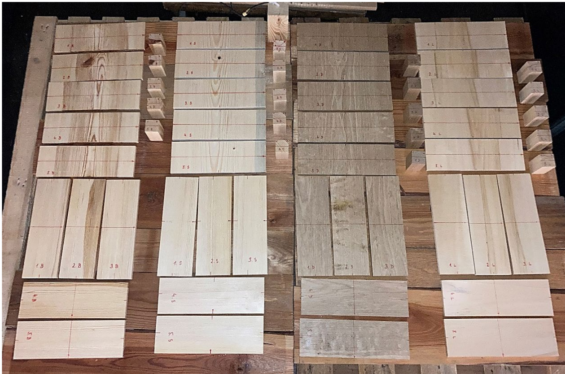
Obr. 7 Vzorky dřeva po ošetření v termokomoře (zleva borovice, smrk, dub, lípa)
