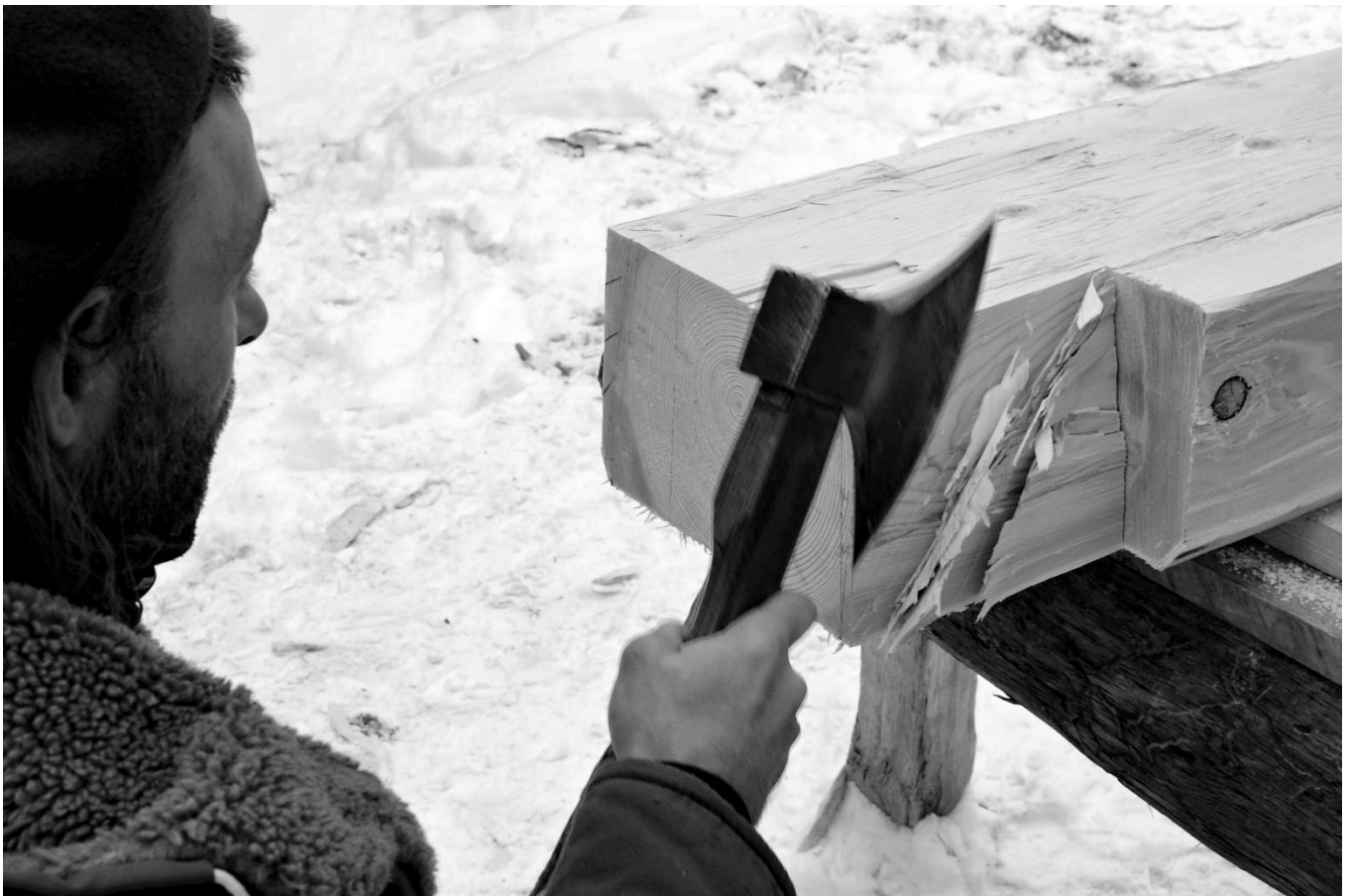
38 37 a 38 Při výrobě stáječících se ploch sekerou je nutné postupovat z obou stran.
