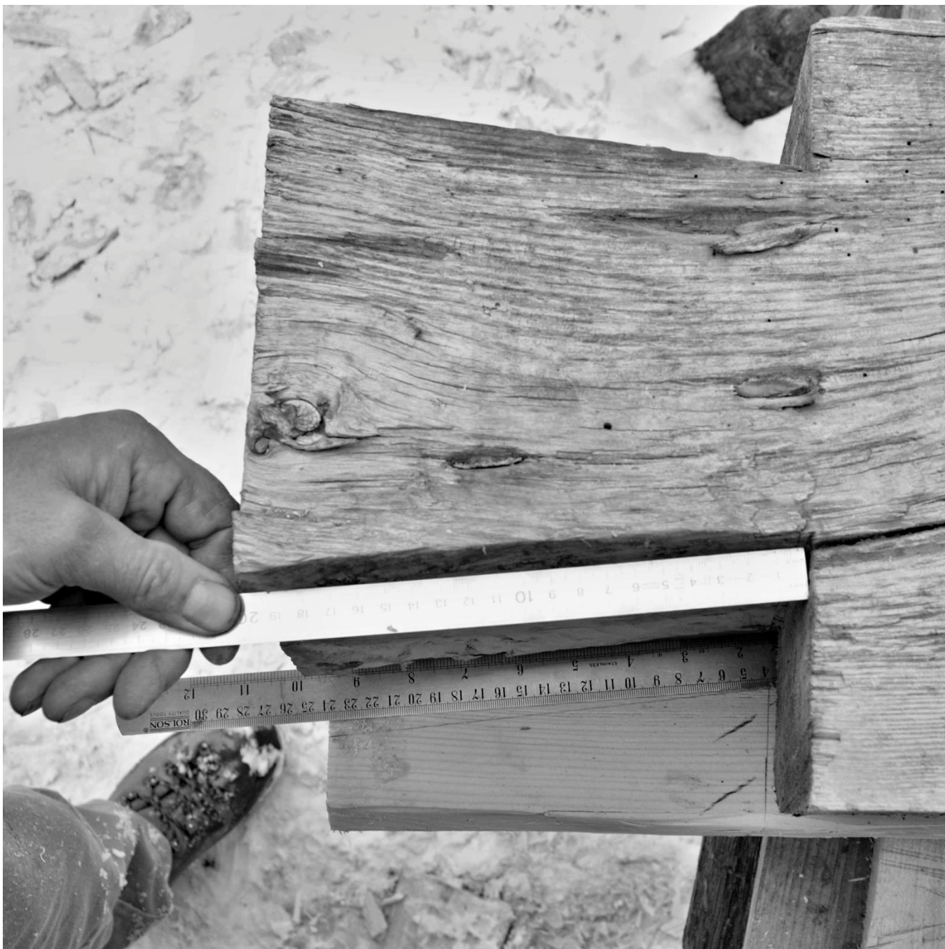
32 Vidíme, že obě linky se vzájemně rozbíhají. Označíme si je a v pravou chvíli přerýsujeme do jejich skutečné polohy. Stejně postupujeme i na sousední ploše.
