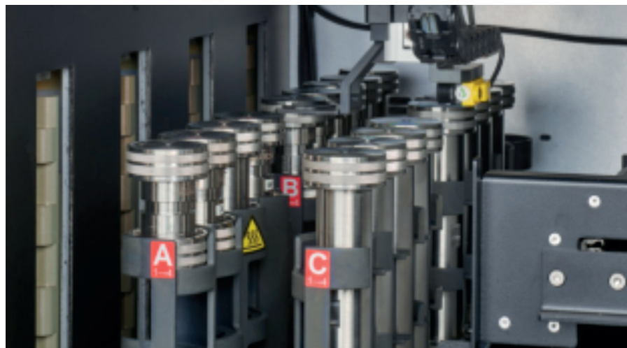
Obr. 3: Extrakční cely uvnitř EXTREVA ASE
