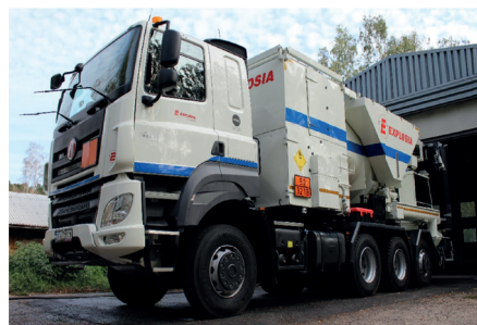
Obr. 3: Nabíjecí vůz určený pro nabíjení směsí trhavin přímo do vývrtů v kamenolomech
