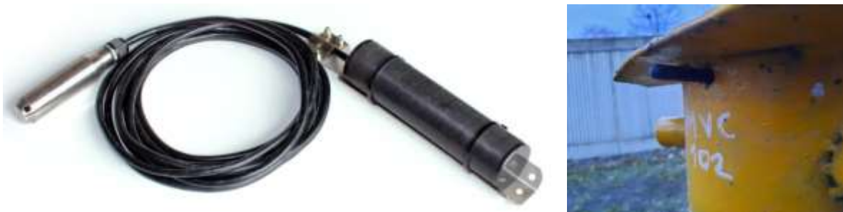
Obr. 1.: Vlevo: sonda pro měření hladiny vody s GSM komunikací a akumulátorovým napájením; vpravo: příklad instalace na lokalitě do vrtu – detail umístění externí antény.
