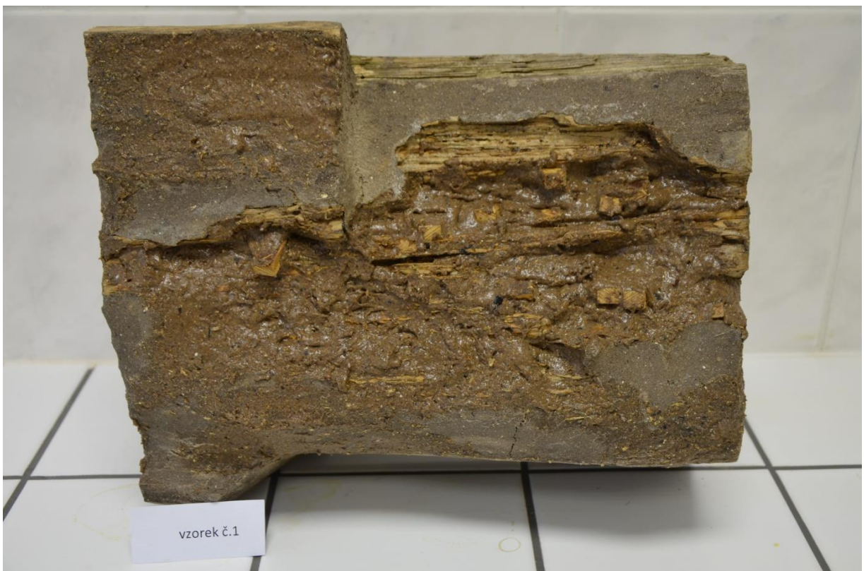
Obr. 16 Vzorek po konsolidaci kaseinem – zpevnění hlubokých poškozených míst dřevěnými klínky. Kaseinový tmel se v tak extrémním poškození nanáší v minimálně 2 až 3 vrstvách. Ty se vždy musí nechat sesítovat, opět konsolidovat až poté nanést další vrstvu. Větší či menší trhliny se na závěr vytmelí.
