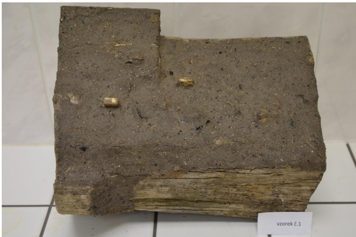
Obr. 17 Vzorek č. 1 – celkový pohled na závěrečné tmelení. Byly použity 3 vrstvy kaseinového tmelu Vzorek bude sloužit dále jako pomůcka při přednáškách a workshopech.
