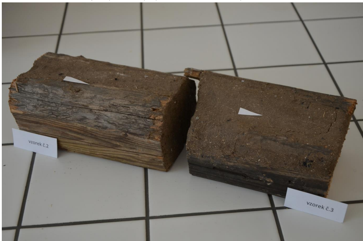
Obr. 18 Vzorek č. 2, 3 – zkušební vzorky odebrané z historické střešní konstrukce, pohled na závěrečné tmelení. Byly použity 3 vrstvy kaseinového tmelu.
