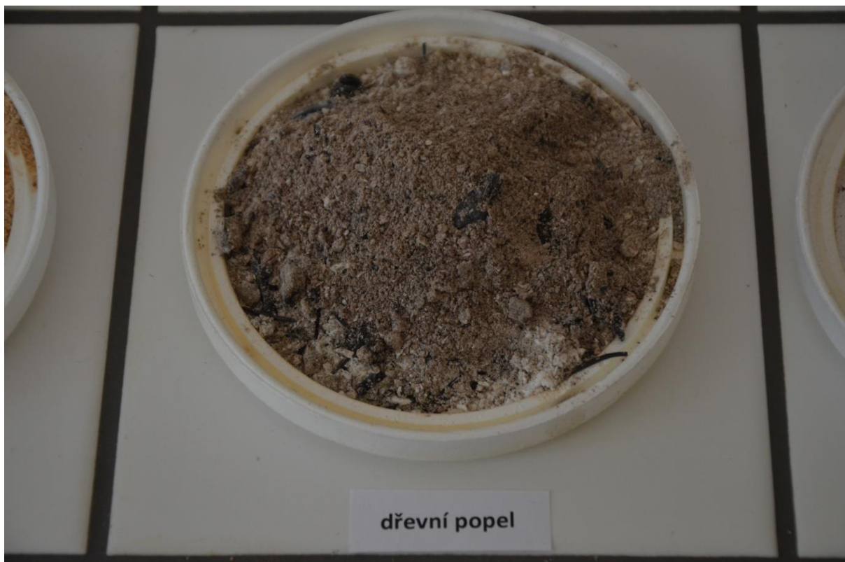
Obr. 5 Suroviny k výrobě kaseinového tmelu – dřevní popel
