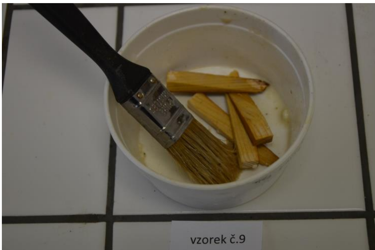
Obr. 12b Klínky jsou napuštěny kaseinovým mazem pro klížení
