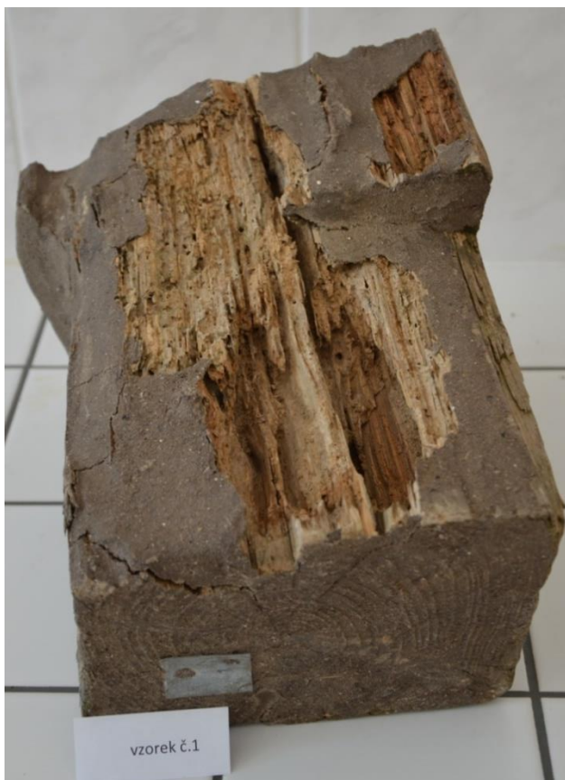
Obr. 13a Vzorek č. 1 degradace poškozeného trámu Obr. 13b Hloubka degradace trámu cca 5cm
