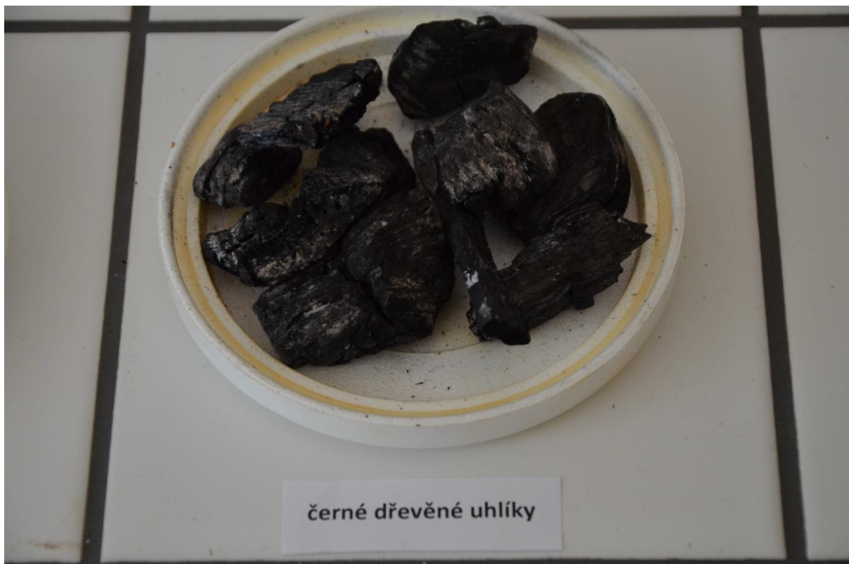
Obr. 7 Suroviny k výrobě kaseinového tmelu – dřevěné uhlíky slouží k zabarvení tmelu
