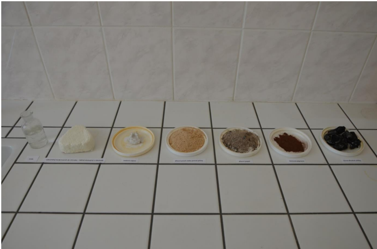
Obr. 1 Veškeré suroviny k výrobě kaseinového tmelu – z leva voda, odtučněný tvaroh, vápenná kaše, dřevní prach nebo jemné piliny, dřevní popel, barevný pigment, dřevěné uhlíky
