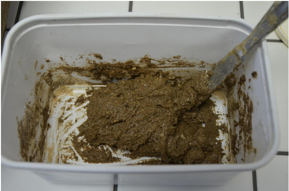
Obr. 15 Výroba kaseinového tmelu, který se doporučuje nanášet v co nejhustší konzistenci, čímž se eliminují i následné trhliny tmelu
