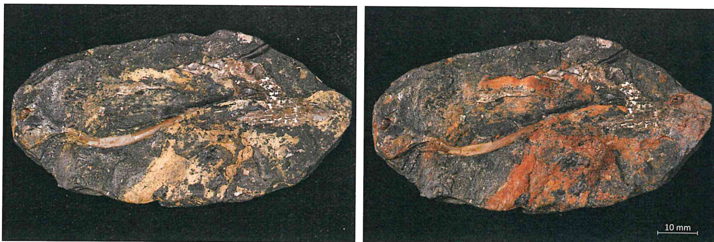
Obrázek 1 Bitumenní jílovec s kostí (karbon, Kounov) silně postižený degradací pyritu. Povrch neošetřeného jílovce (vlevo) je pokrytý žlutavými a bělavými hydráty síranů železa, silně zapáchá emanacemi kyseliny sírové. Po ošetření amoniakem za vysokého tlaku (vpravo) jsou hydratované nestabilní sírany převedeny na stabilnější sloučeniny (hydroxid železnatý, síran amonný).
