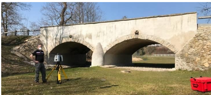
Obr. 11. Stará Dobeč (P) – skenování mostu.
