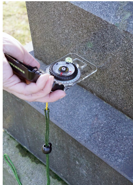
Obr. 31 a–d: Ukázka měření náklonu náhrobní stély pomocí kompasu s inklinometrem a s pomocí geologického kompasu typu Freiberg (vlevo dole). V případě měření pomocí kompasu je zapotřebí změřit zvlášť náklon náhrobku (vpravo nahoře) a zvlášť azimut tohoto náklonu (vpravo dole). Při měření geologickým kompasem lze obě hodnoty odečíst naráz. Náhrobek kamenického mistra Ernesta Fischera na starém hřbitově ve Skorošicích.
