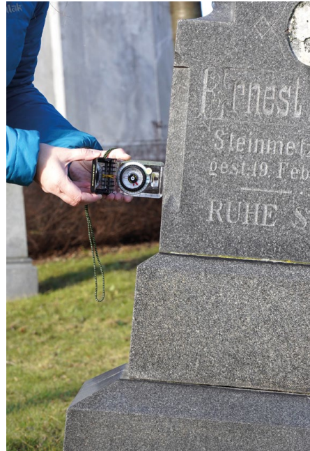
Obr. 31 a–d: Ukázka měření náklonu náhrobní stély pomocí kompasu s inklinometrem a s pomocí geologického kompasu typu Freiberg (vlevo dole). V případě měření pomocí kompasu je zapotřebí změřit zvlášť náklon náhrobku (vpravo nahoře) a zvlášť azimut tohoto náklonu (vpravo dole). Při měření geologickým kompasem lze obě hodnoty odečíst naráz. Náhrobek kamenického mistra Ernesta Fischera na starém hřbitově ve Skorošicích.
