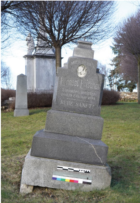
Obr. 31 a–d: Ukázka měření náklonu náhrobní stély pomocí kompasu s inklinometrem a s pomocí geologického kompasu typu Freiberg (vlevo dole). V případě měření pomocí kompasu je zapotřebí změřit zvlášť náklon náhrobku (vpravo nahoře) a zvlášť azimut tohoto náklonu (vpravo dole). Při měření geologickým kompasem lze obě hodnoty odečíst naráz. Náhrobek kamenického mistra Ernesta Fischera na starém hřbitově ve Skorošicích.
