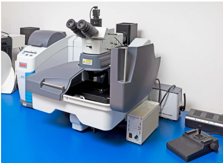
Obr. 3: Fotografie Ramanova mikroskopu Nicolet DXR2 od firmy Thermo Scientific, USA, který je také součástí vybavení laboratoře NTM.
