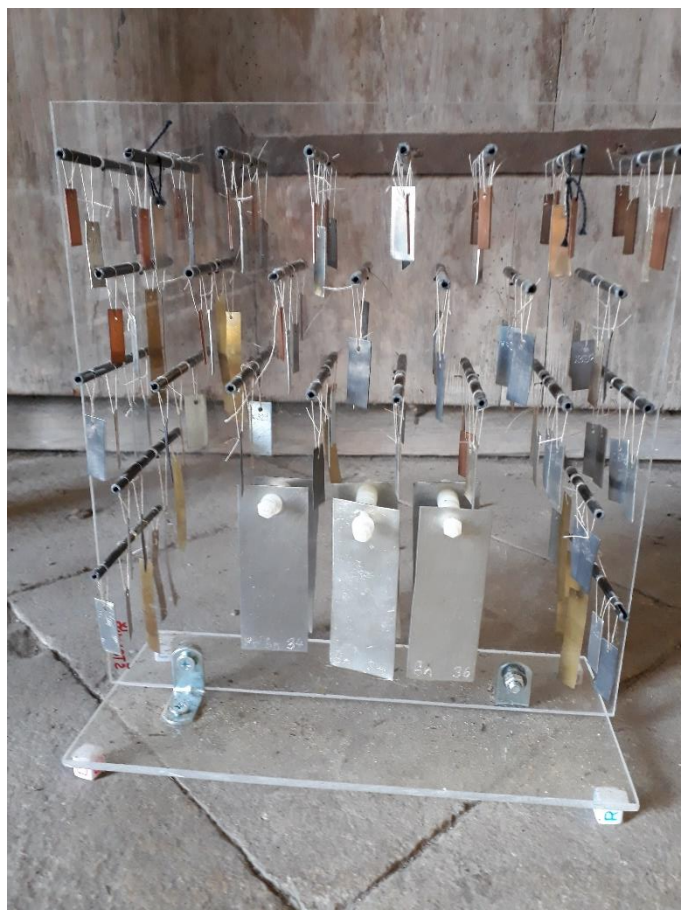
Obrázek 4 Expozice korozních kupónů ve svislé pozici
