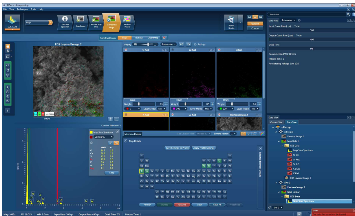
Obr. 6 Jako příklad je uvedený software Aztec je ovládací software pro EDS, který umožňuje plné ovládní metody. EDS spektrum je vidět vlevo dole.
