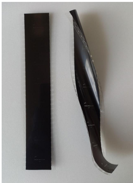
Obr. 13 Filmový pás bez dezinfekce (vlevo) a po dezinfekci parami butanolu (vpravo)
