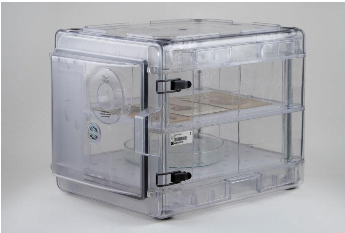
Obr. 5 Plastový exikátor pro dezinfekci parami n-butanolu
