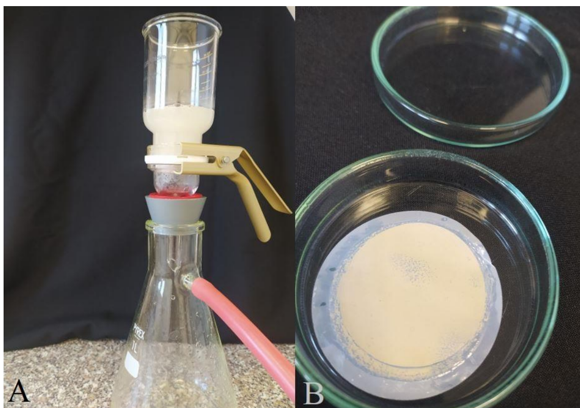
Obr. 5. Průběh vakuové filtrace prvního podílu (A) a vzorek pro datování před vysušením (B).
