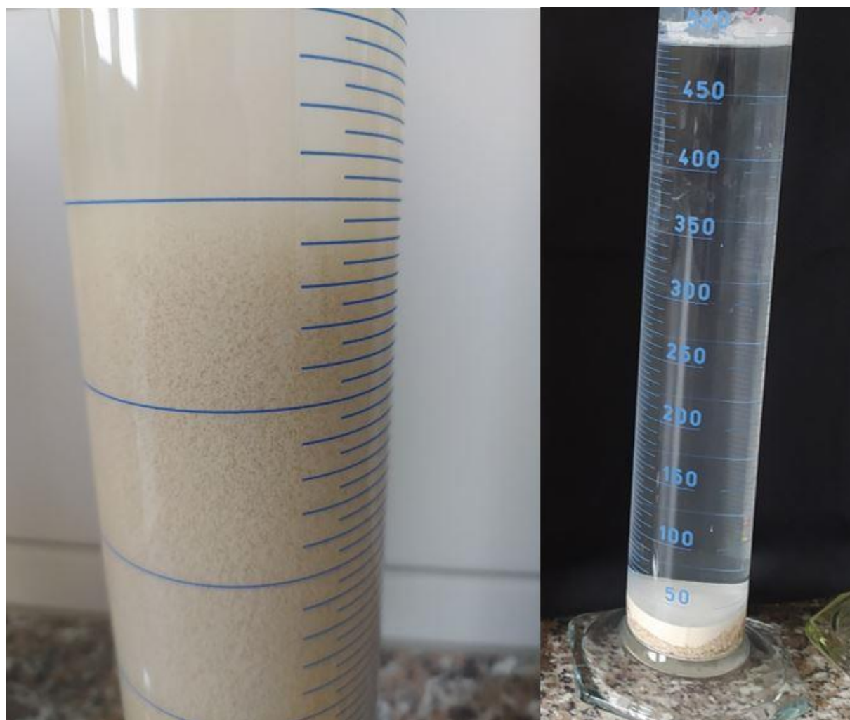
Obr. 8. Koaguace a následná rychlá sedimentace vzorku.
