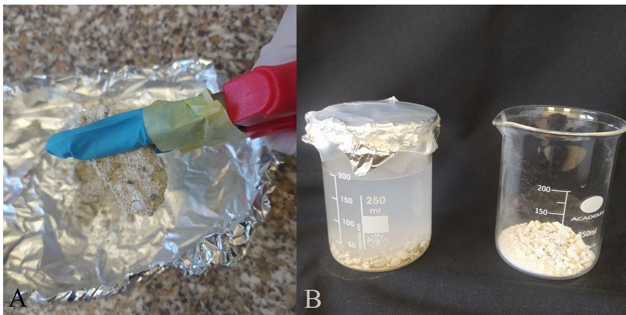
Obr. 1. Drcení očištěného vzorku malty pomocí kleští (A) a zalití roztokem „agentu“ (B).
