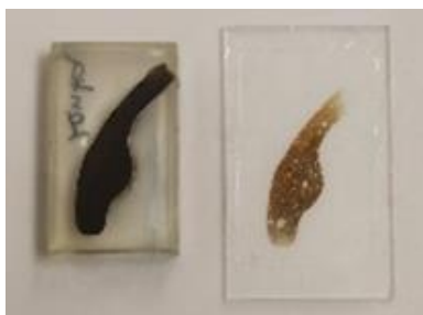
Obr. 8: Ukázka vstupní úpravy (zalití a vakuování) vzorků pórovité keramiky, vlevo dole ukázka nábrusu (vlevo) a výbrusu (vpravo)
