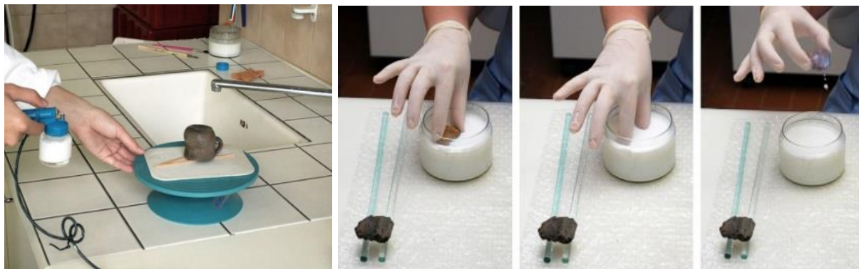
Obr. 15: Konsolidace postříkem airbrushem a ponorem
