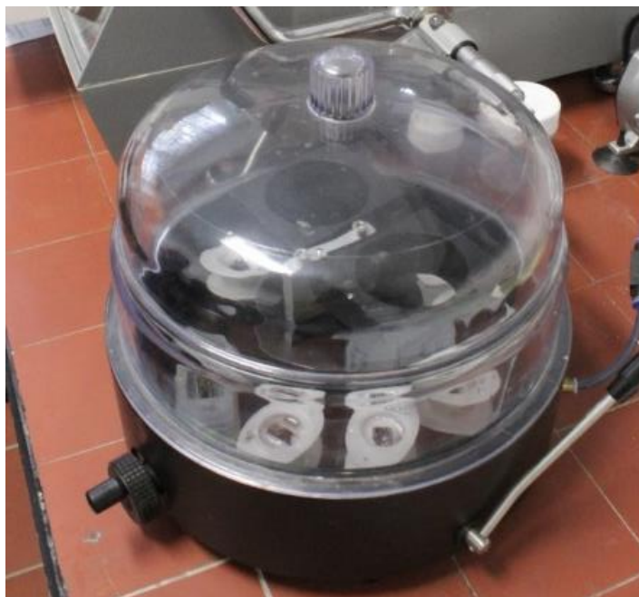
Obr. 8: Ukázka vstupní úpravy (zalití a vakuování) vzorků pórovité keramiky, vlevo dole ukázka nábrusu (vlevo) a výbrusu (vpravo)
