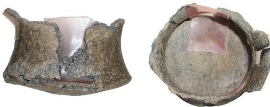
Obr. 2C-14: Otevřené formy z dentálního vosku, připravené k nanášení tmelu
