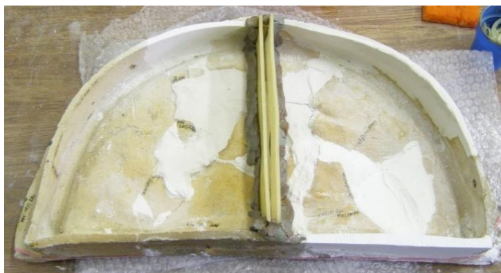
Obr. 3A-15: Otevřená forma z parafínu pro dolití žebra z vnitřní části polychromního reliéfu, celkový pohled
