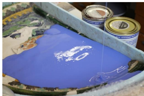
Obr. 3A-19: Postupné lití silikonové hmoty na zaformovaný polychromní reliéf
