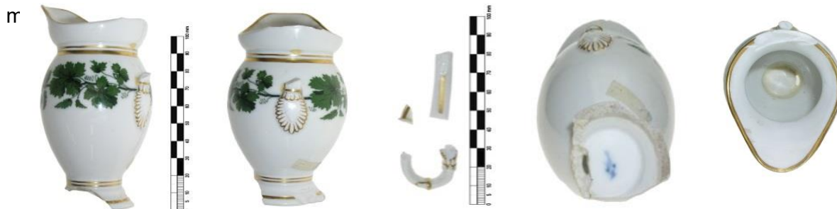
Obr. 3C-2: Stav porcelánové mlékovky při převzetí (celkový pohled, rozbité ucho na tři části - detailní pohled, stav spodní části, usazené sedimenty uvnitř)
