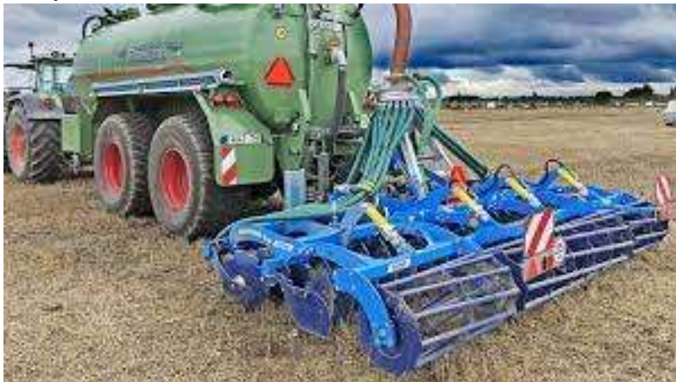
Obr. 4: Souprava aplikátoru tekutých statkových a kapalných organických hnojiv s disky
