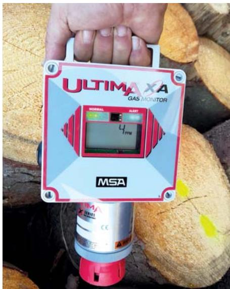
Obrázek 2.3.6: Měřicí přístroj MSA Ultima XA.
