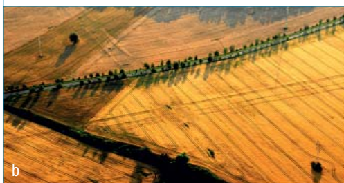
Obr. 5.16 Příklady lineárních systémů zviditelněných porostovými příznaky: (a) meliorace; (b) moderní produktovody.
