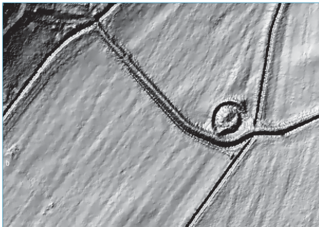
Obr. 5.27 (a) Linie dvou zaniklých paralelních příkopů zviditelněných porostovými příznaky na ortofotografii serveru Mapy.cz; (b) tvrzíště ukryté v lesíku pod příkopy zviditelněné na digitálním modelu terénu odvozeném z leteckých lidarových dat (geoportál Českého úřadu zeměměřického a katastrálního).
