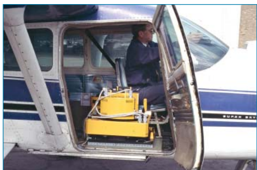
Obr. 3.3 Speciální letecká fotokamera sloužící k pořizování kolmých (měřických) fotografií připevněná k podlaze letounu Cessna 172 Skyhawk.
