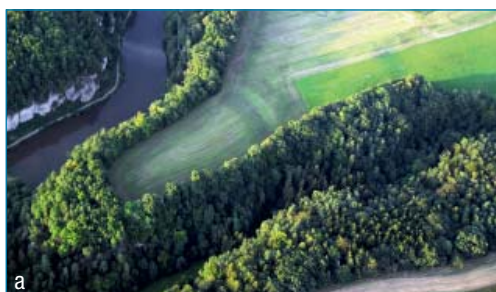
Obr. 5.14 Vegetací zvýrazněný zaniklý napájecí kanál (vlevo) poděbradské rybníční soustavy (16. století). Dobře jsou vidět také dvojité linie: zaniklé cesty/silnice (uprostřed) a dvou paralelních produktovodů (Senice).
