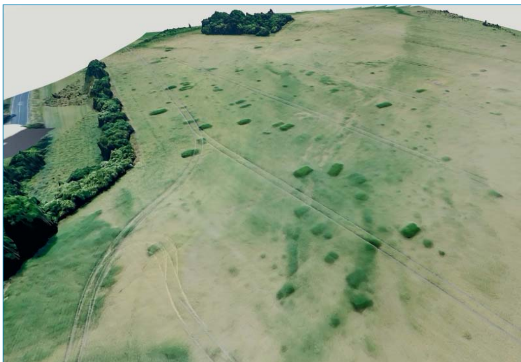
Obr. 5.28 Fotogrammetrickým postupem vytvořený 3D model pravěkého sídliště v Račíněvesi s bodovými a liniovými objekty zviditelněnými porostovými příznaky (autor: J. Unger).
