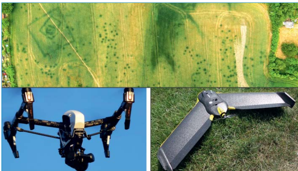
Obr. 3.12 Kolmá letecká fotografie části pravěkého sídliště na Litoměřicku (nahore) pořízená z dronu DJI Inspire 1 kamerou Zenmuse X5 s originálním rozlišením 4 600 × 3 448 pixelů. Vedle klasických dronů (vlevo dole) jsou pro fotogrammetrické snímkování vegetací zviditelněných pravěkých areálů využívána také křídla (vpravo dole).
