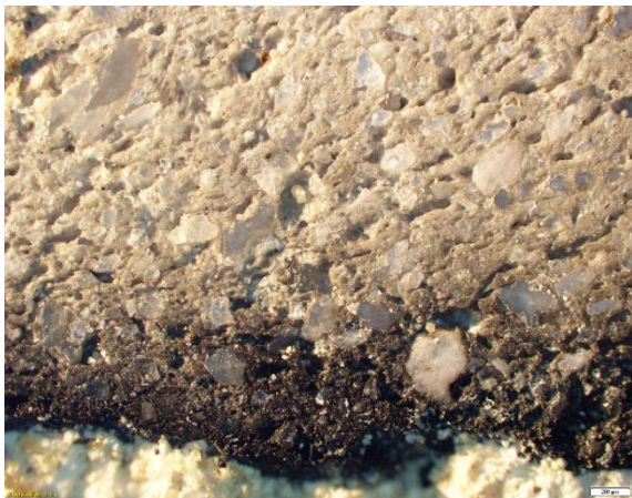
c Přechod mezi černou povrchovou úpravou a vnitřní šedou hmotou. Nábrus vzorku DJN 2.
