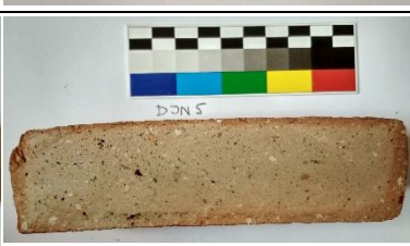
DJN 5 Úlomek dlažby. Lokalizace neznámá (umístěna volně pod lavicemi vpravo – přístup zezadu). Cihlově červená barva přecházející ve středu do šedo-béžové. Úlomek 14 x 6 x 3,5 cm včetně skosených okrajů a zbytků ložné malty. Výška dlaždice 3,7 cm.
