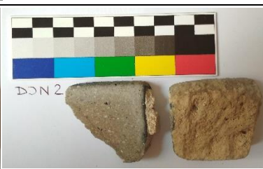
DJN 2 Úlomek dlažby. Lokalizace neznámá. „Černá“ dlaždice, okrová-šedá s černou povrchovou úpravou se zbytky ložné malty. Úlomek 3 x 4 x 3,7 cm. Výška dlaždice 3,7 cm.
