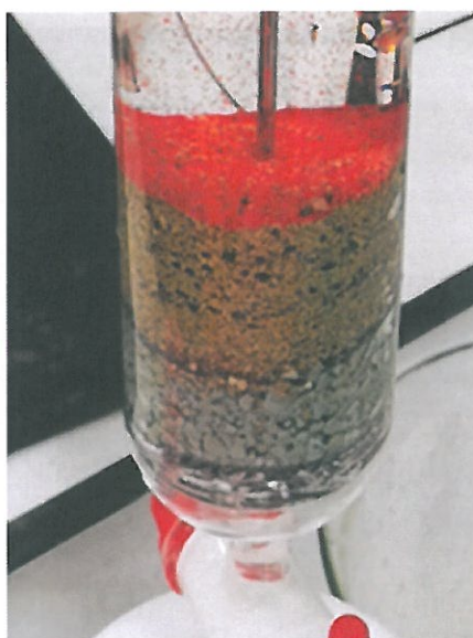
Obr. 13: Detail sorpční kolony během prolití PE koulí
