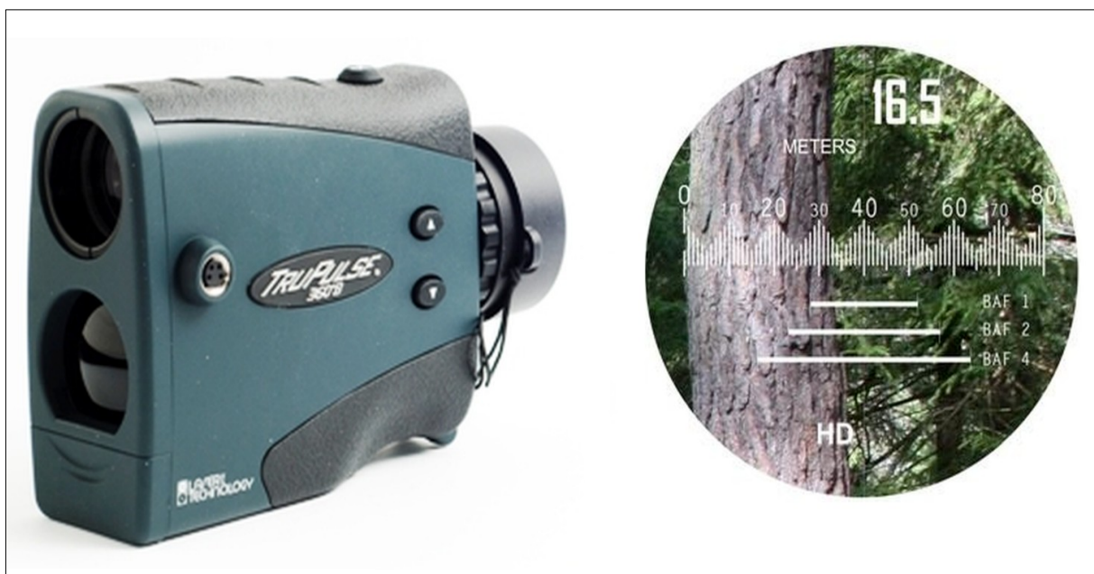
Obrázek 4. Ukázka lesnického dálkoměru s funkcí vzdáleného měření průměru a ukázky měření (zdroj https://www.fieldmap.cz/ )
