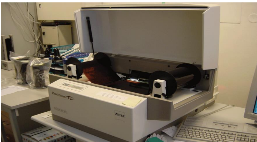
Obrázek 18 Fotogrammetrický skener TD1 firmy Zeiss-Intergraph
