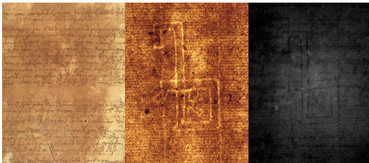
Obr. 38: Listina s filigránem v místě textu. Pozorování v dopadajícím VIS (vlevo), ve spodním rozptýleném světle (uprostřed) a v dopadajícím VIS s krátkovlnným filtrem RG925 (vpravo).
