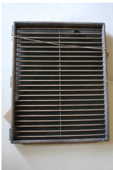
Obr. 16: Rám čerpací formy ze spodní strany.
