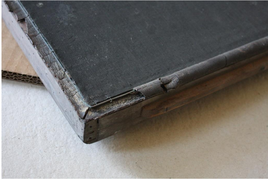
Obr. 23: Ukázka historické čerpací formy s dochovanými fragmenty kožené dutinky zamezující protékání papírové kaše mezi sítím a příklopným rámem.
