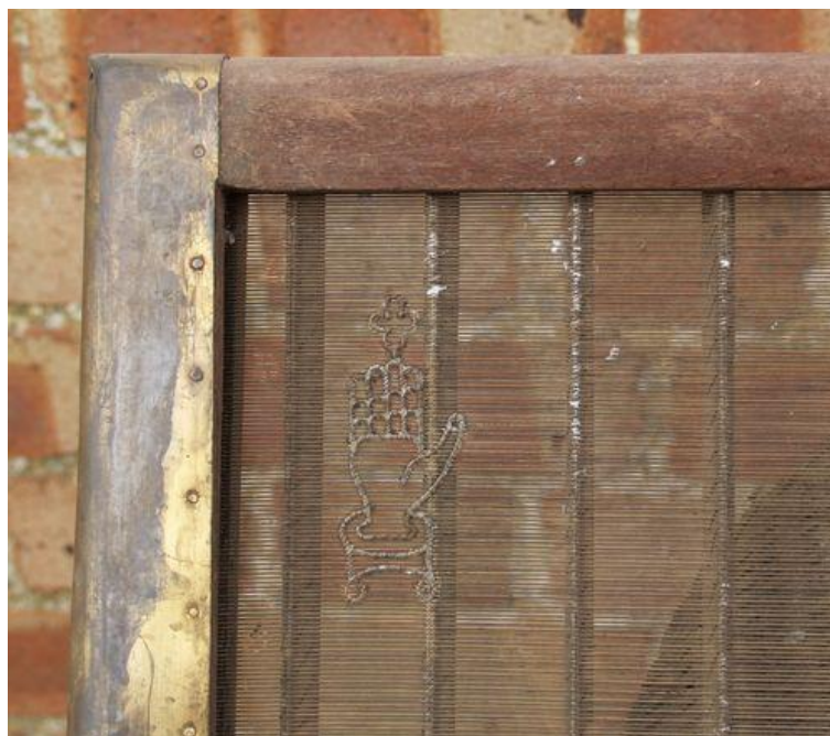
Obr. 20: Detail filigránu připevněného do rohu formy. Osnovní dráty zde lícují se žebry.
