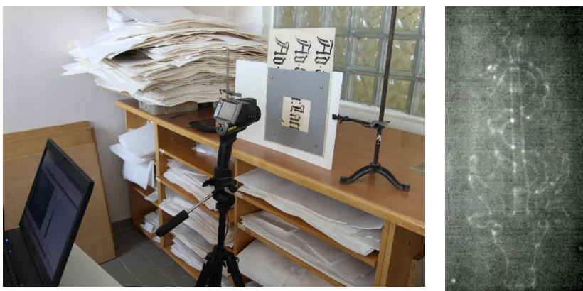
Obr. 40: Způsob uchycení dokumentu, za nějž se přibližuje nahřáté těleso a výsledný snímek termografie
