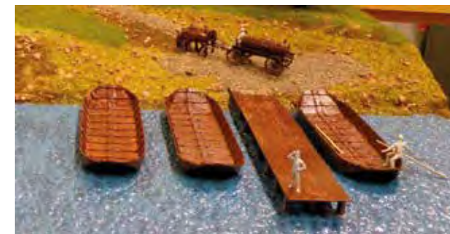
Obr. 4.3.3 Říční prámy s plochým dnem a velmi nízkým ponorem používané římskými legiemi k plavbě na méněvodných řekách (P. Sedláček)
