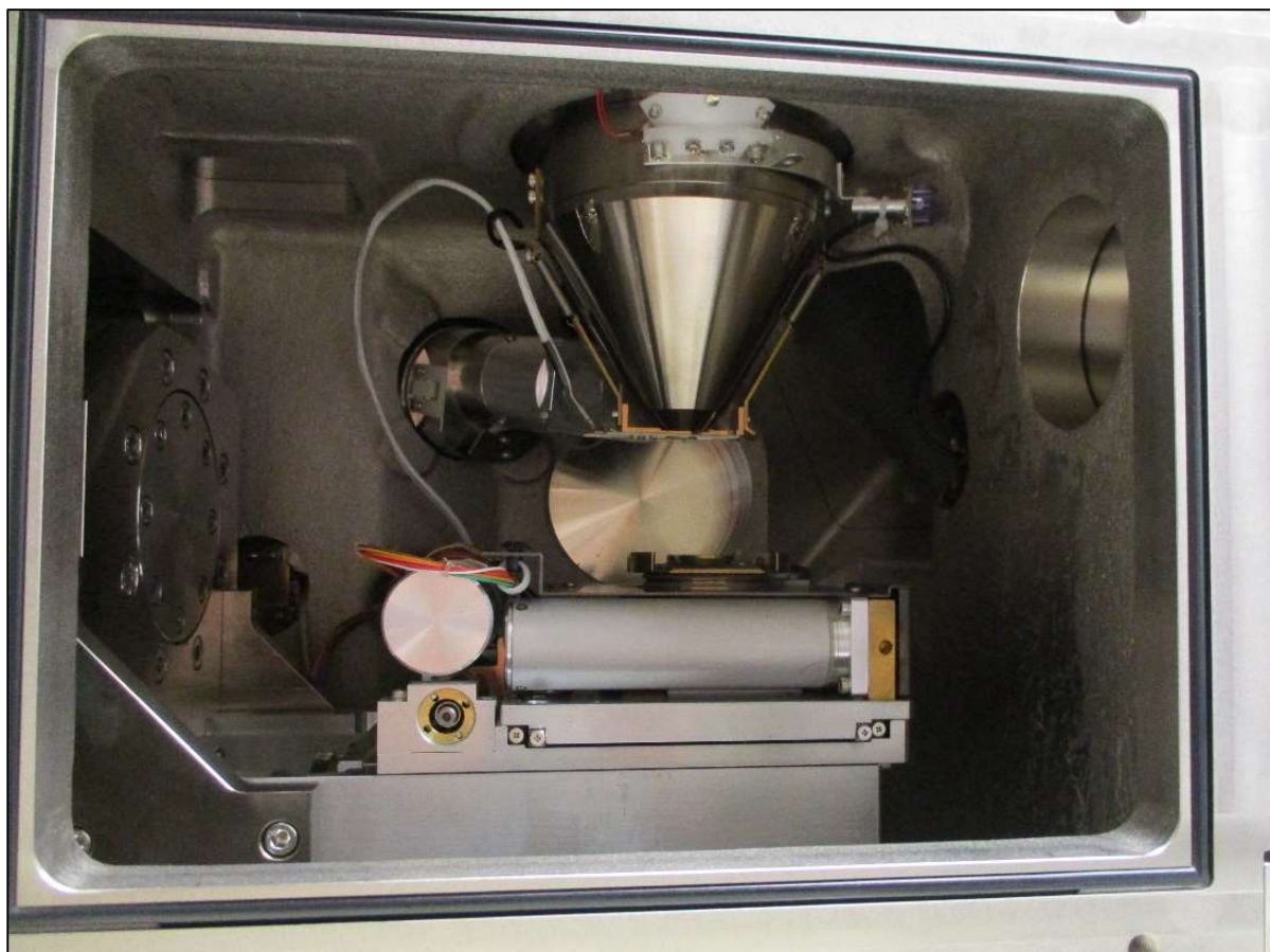
Obr. 7: Komora elektronového mikroskopu SEM (spodní strana záběru 30 cm; Ústav geologických věd PŘF MU Brno).
