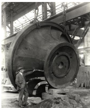
Obr. 4.178: Výroba oběžného kola Francisovy turbíny pro MVE Mířežovice (převzato z: firemní materiály ČKD Blansko).
