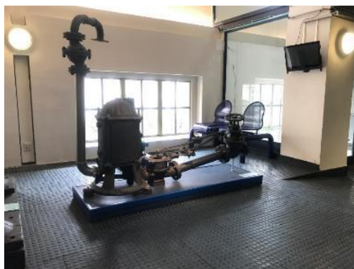
Obr. 4.201: Nové Dvory u Kutné hory – trkač (čerpadlo založené na využití kinetické energie proudící vody) nahradil původní čerpadlo, poháněné vodním kolem, pravděpodobně v roce 1897. Až do poloviny 50. let 20. století zásoboval užitkovou vodou velkostatek a místní zámek. Zdrojem vody byl místní rybník, voda byla vytlačována do věžového vodojemu, odkud proudila do místa určení. V 90. letech 20. století byl prodán rybník, věž a hrázděný dům obsluhy skončily v dezolátním stavu a trkač byl zapomenut. K jeho nalezení, vyzvednutí a rekonstrukci došlo v letech 2014–2016 (Nové Dvory). Foto archiv PVK.
