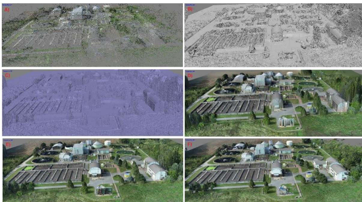
Obr. 4.272: Geneze 3D modelu velké komunální ČOV v jednotlivých krocích: (A) identifikace společných bodů na jednotlivých fotografiích; (B) vytvoření mračka bodů; (C) vytvoření drátového modelu; (D) přiřazení barevné škály 3D modelu z jednotlivých fotografií; (E) texturování modelu; (F) finální úprava textur. Radek Bachan, 2021.
