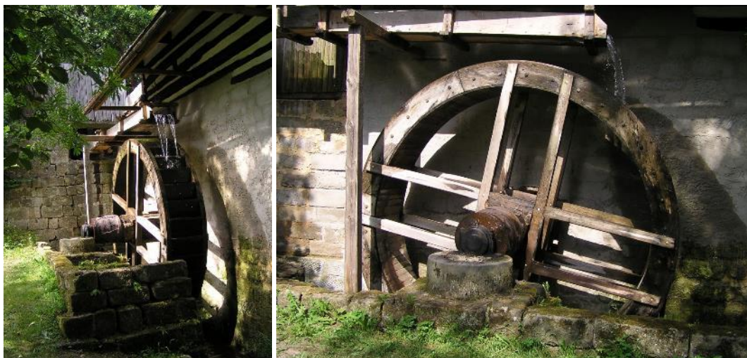
Obr. 4.165: Korečník na vrchní vodu. Foto Radim Urbánek, 2006.
