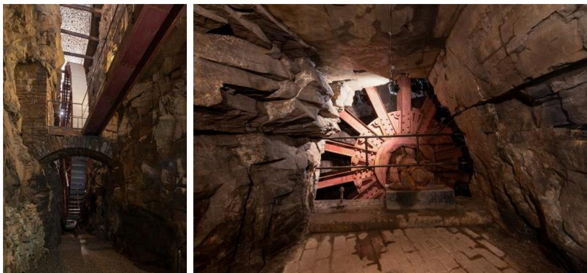
Obr. 4.166: Příbram, důl Drkolnov – vodní kolo o průměru 12,4 m. Foto Viktor Mácha, 2019.
