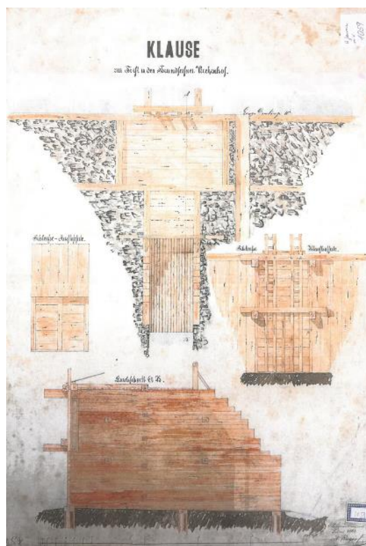
Obr. 5.10: Schéma Rudolfa Riegera z roku 1863 s původním provedením hráze klauzy na Splavském potoce (převzato z: SZA, pobočka Olomouc, inv. č. 1059).
