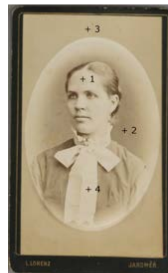
Obr. 14: Ukázka – vyhodnocení světlostálosti historické fotografie (albuminotypie). Vlevo – fotografie s vyznačenými místy měření, nahoře – křivky celkové barevné změny \Delta E , porovnané s naměřenými hodnotami standardů modré vlny BW1-3 (v čase 30 min). Celková barevná změna \Delta E je vypočítána dle rovnice (1).
