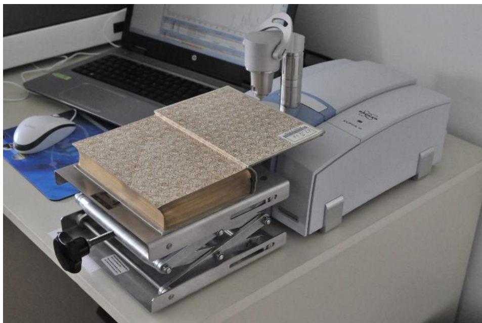
Obr. 12: Vhodná pozice knihy pro měření technikou ATR-FTIR
