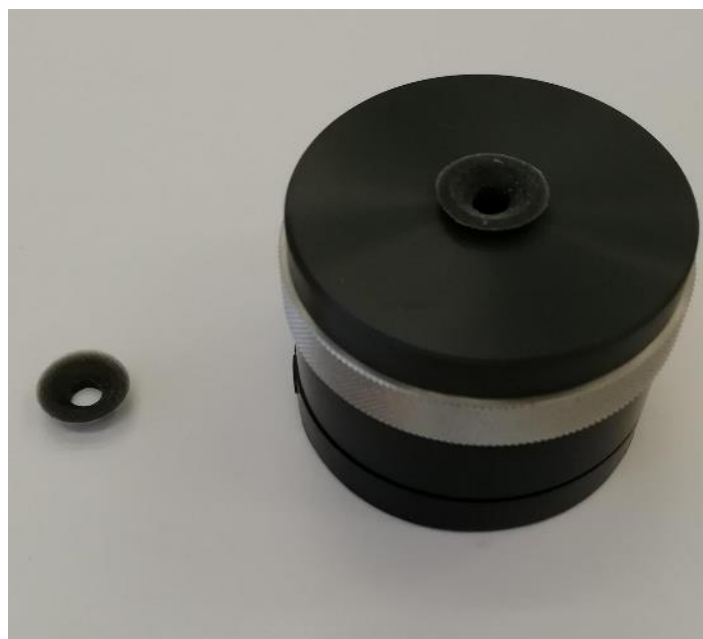
Obr. 30: Těsnící pryžový kroužek: vlevo náhradní pryžový kroužek; vpravo pryžový kroužek připevněný k výměnné měřicí hlavě
