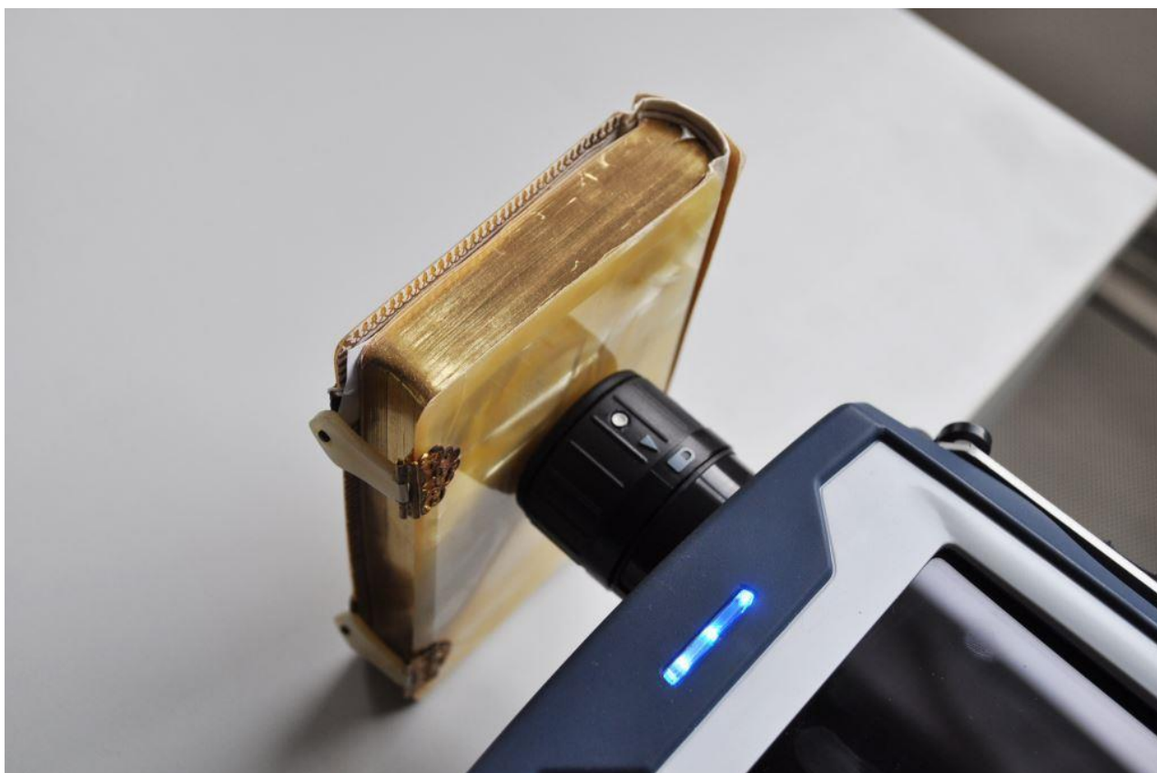
Obr. 31: Ukázka průběhu měření knižní vazby ručním Ramanovým spektrometrem Bruker BRAVO
