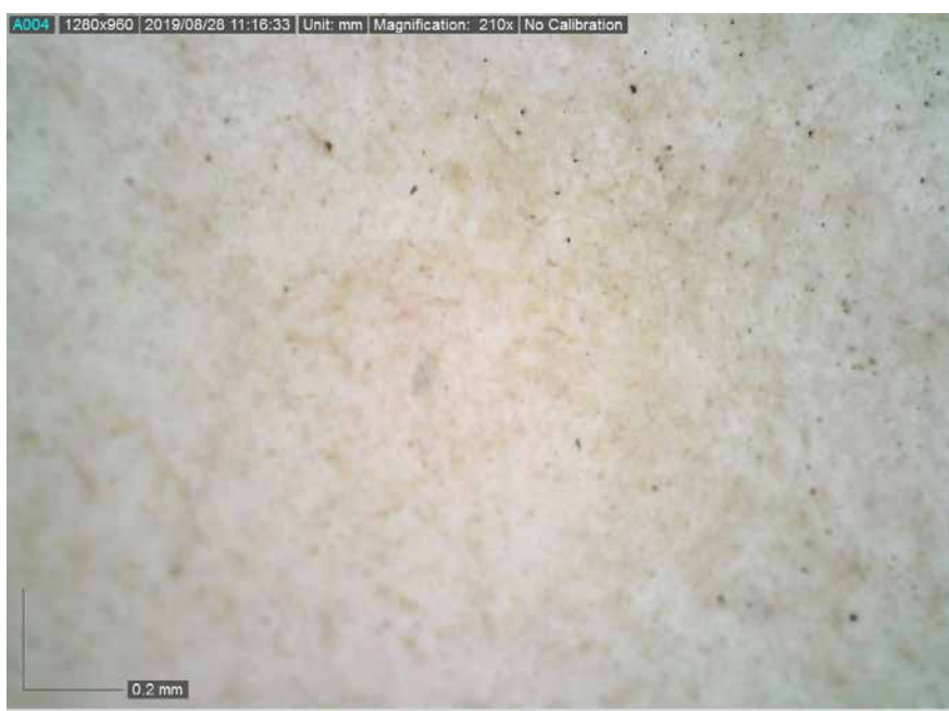
Ztenčená nátěrová vrstva, prosvítající dřevitý papír
