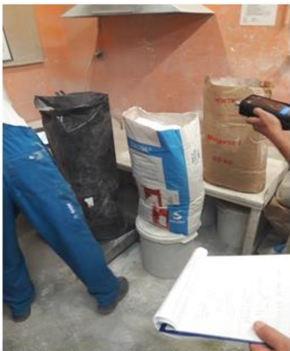
Obrázek 3β - Navažování složek do speciálních omítek
