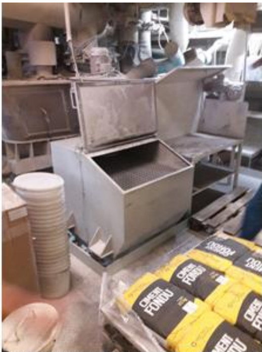
Obrázek 29 - Doplňování složek do suchých směsí
