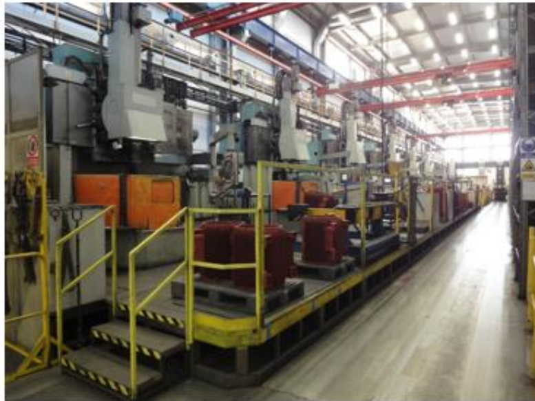
Obrázek 17 - Broušení litiny koster a štítů
