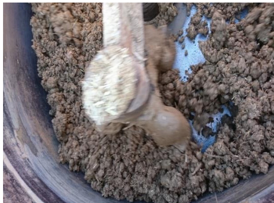
Obr. 11: Konzistence hliněného těsta připraveného k výrobě mlátu „suchou cestou“.
