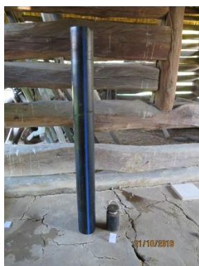
Obr. 18 Zkušební zařízení s vodící trubkou a beranem
