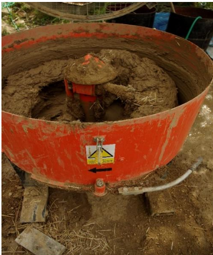
Obr. 4: Homogenizace hliněného těsta v míchačce s nuceným oběhem.
