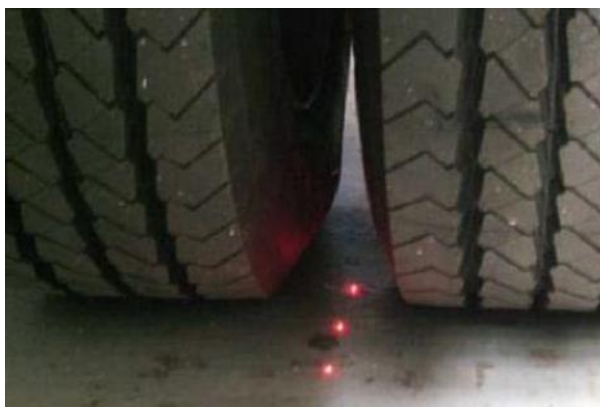
Obr. 5: Laserové paprsky 3 snímačů na povrchu měřené vozovky, foto: archiv CDV
