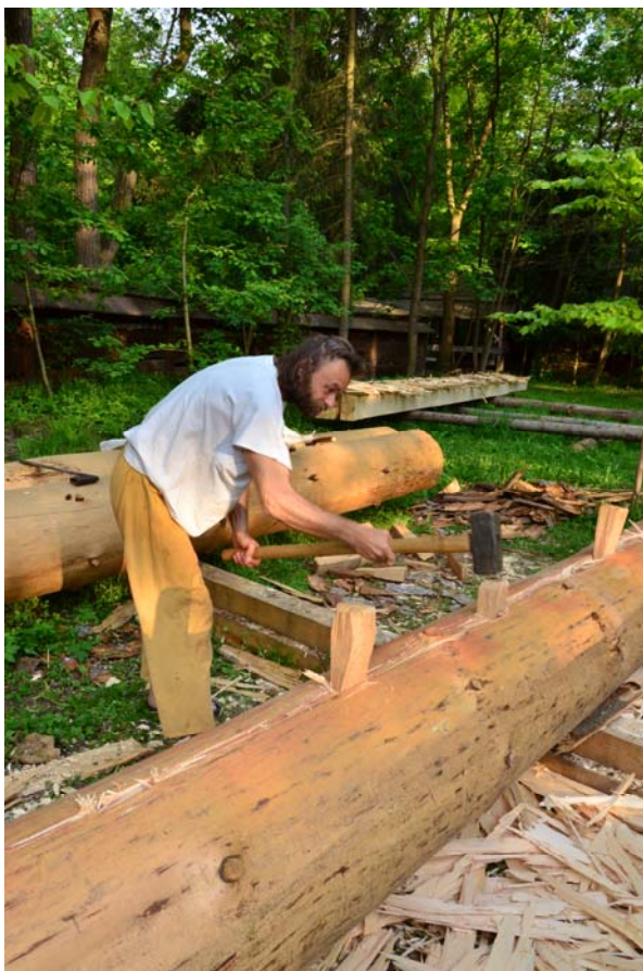
Obr. 24 Postupné zatloukání klínů při štípání
