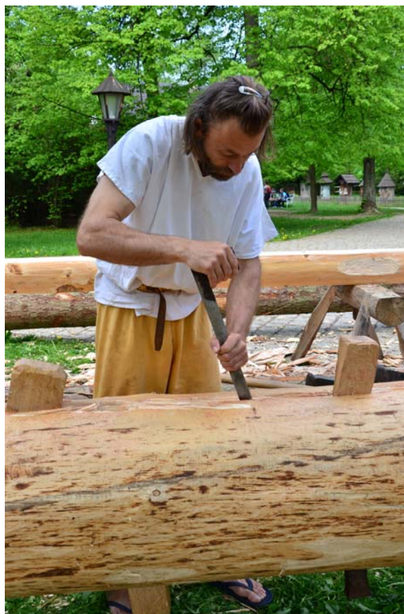
Obr. 25 Přetínání točitých vláken ve štěpné spáře
