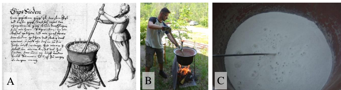
Obrázek 9: Výpal sádry na nízkou teplotu na dobové ilustraci (Götz et al. 2018; A), při současném experimentu (B) a detail povrchu nadrceného sádrovce, ze kterého při varu uniká voda (C).
