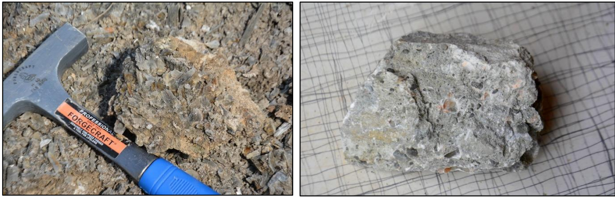
Obrázek 1: Makroskopické snímky sádrovců získaných při vzorkování. Vlevo surovina z lomu Kobeřice s velkými šedo-hnědými krystaly sádrovce a vpravo surovina z dolu Preinsfeld typická jemnozrnější strukturou a výskytem růžových krystalů K-živců
