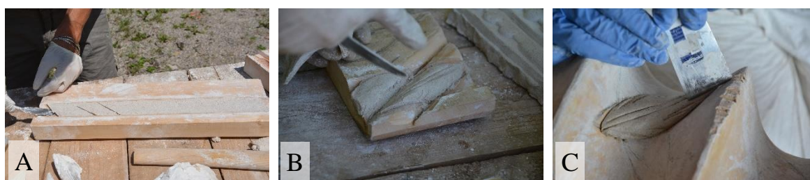
Obrázek 14: Ukázky výroby lístků v různých formách (A–C). Vybraná forma (C) má tvar rotačního hyperboloidu (přímkové plochy).
