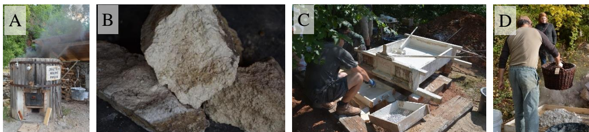
Obrázek 8: Výpal vápna proběhl v experimentální vápenné peci. Kusové vápno bylo vyhašeno v přebytku vody na vápennou kaši a ponořením do vody v koši na vápenný hydrát. Výpal vápna dřevem ve shora otevřené periodické peci (A), kusové vápno pálené z chýnovského vápence (B), přelévání vápenného pačoku do vápenné jámy přes 1 mm síto (C), hašení vápna na prach (D).
