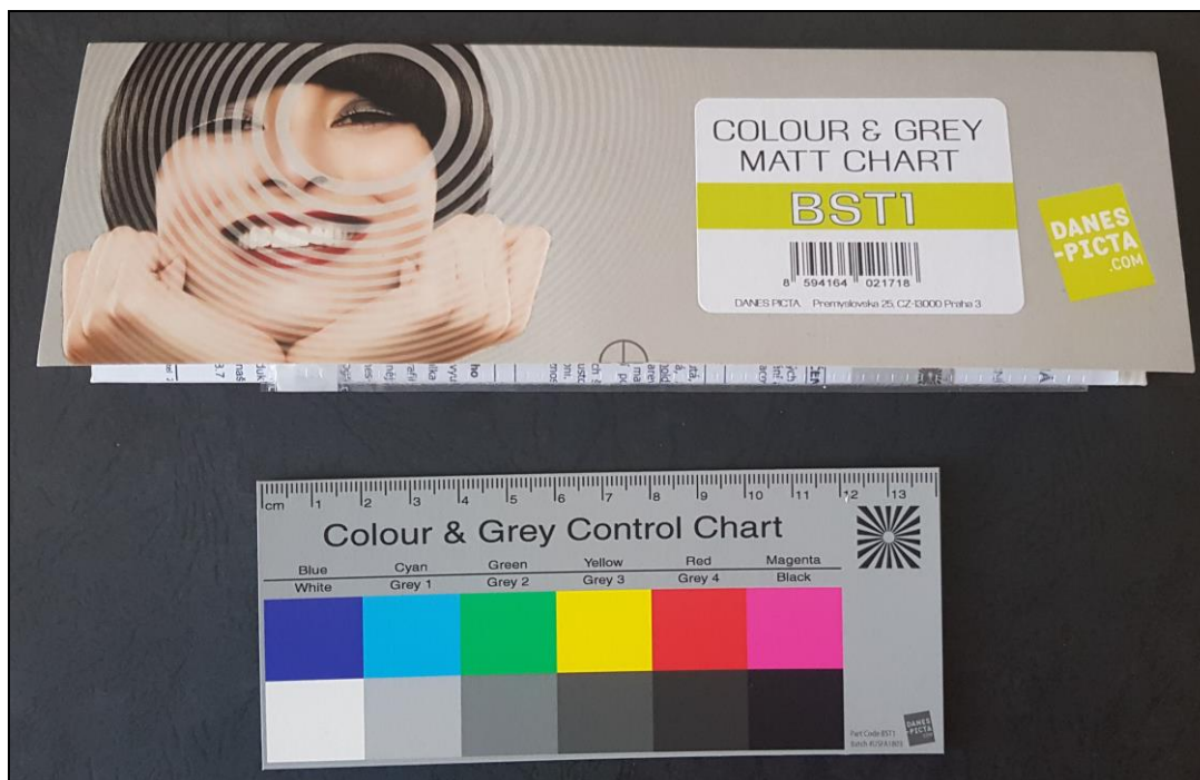
Obr. 7 Ukázka vloženého kalibrovaného proužku se základními barvami (zajištění konzistence výsledků)
