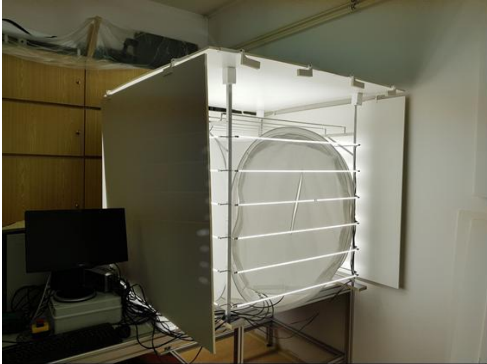
Obr. 8 Ukázka realizace bezstínového osvětlení pomocí kombinace látkového "softboxu", pásků s LED diodami orientovanými od softboxu. Světlo diod se odrazí od papírových desek se sendvičovou konstrukcí a k úplnému rovnoměrnému osvětlení pak dochází průchodem tohoto rozptýleného světla přes stěnu softboxu
