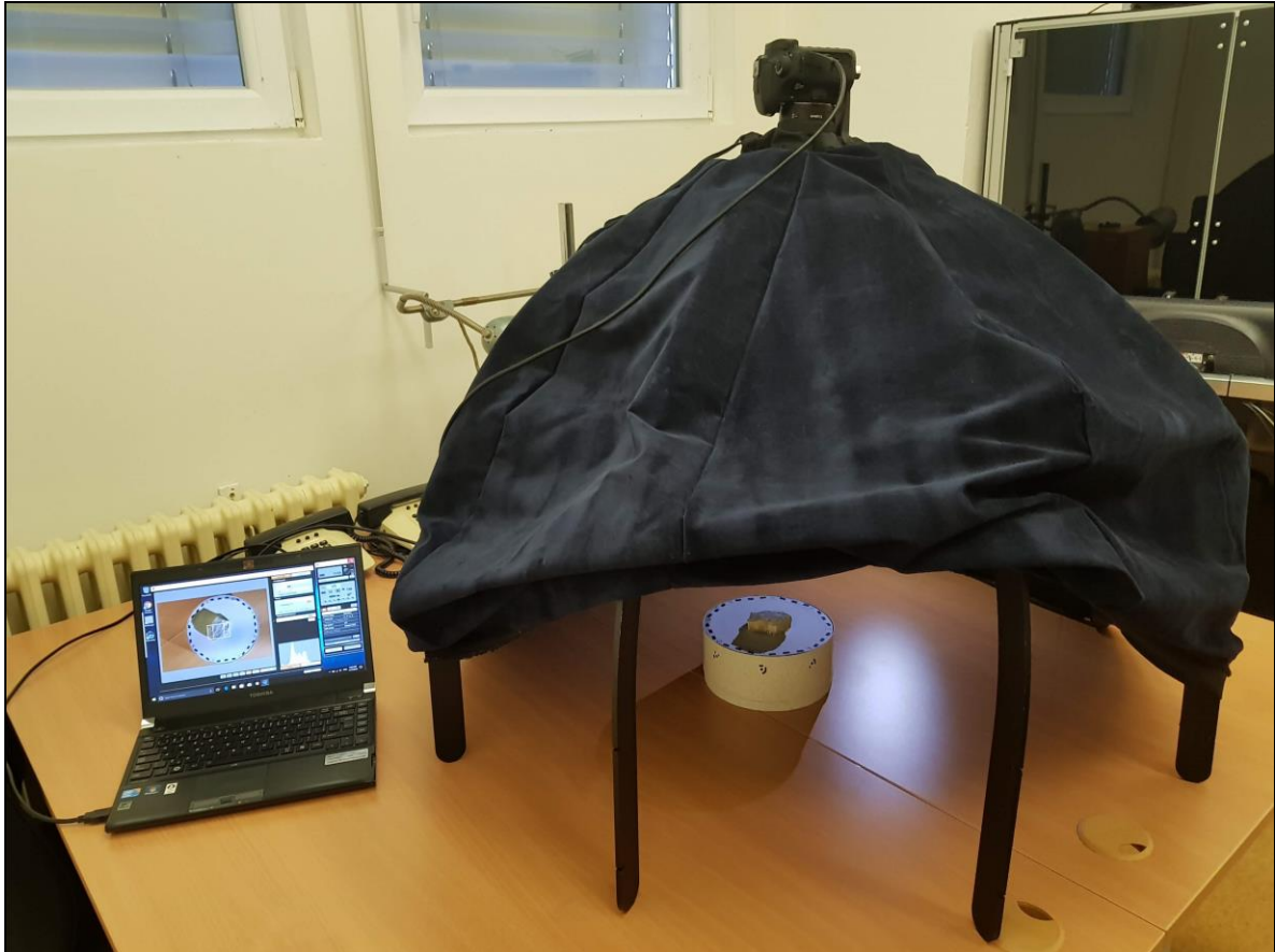
Obr. 5. Ilustrativní fotografie části konstrukce duálního digitalizátoru pro fotometrické stereo se stíněním (přehoz), zajišťujícím definované vnitřní podmínky osvětlení
