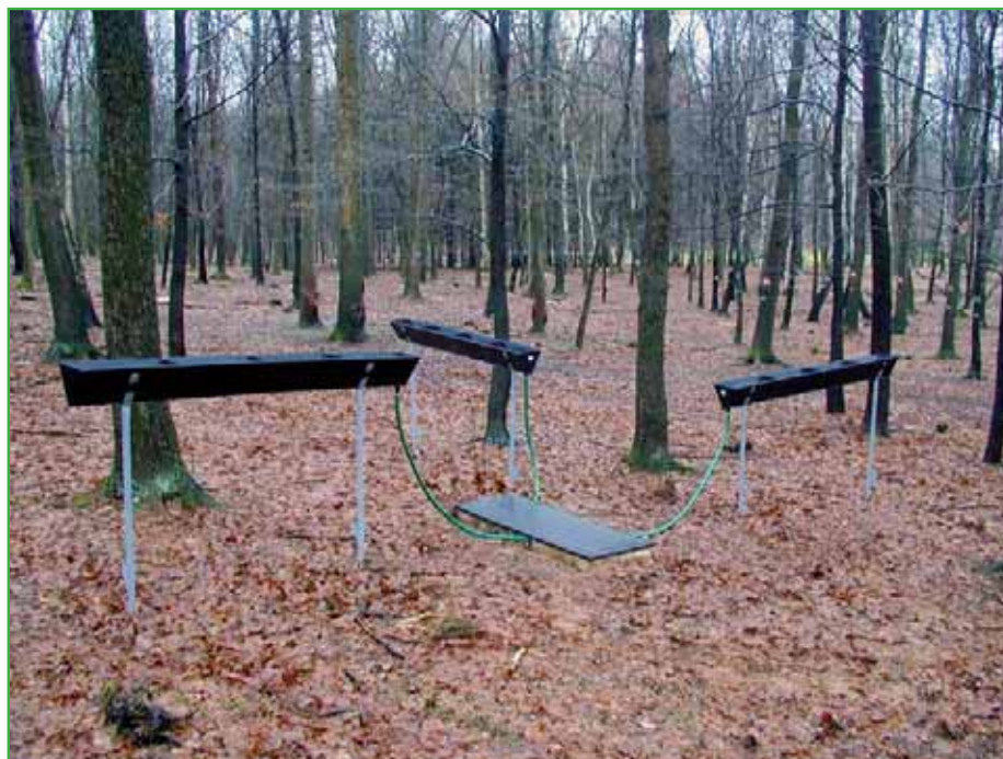
Foto 4.2.4.2 Zařízení pro sběr podkorunových srážek na ploše Březka Collectors for throughfall deposition in the plot Březka
