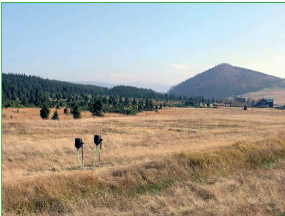
Foto: Zařízení pro sledování depozic na volné ploše Jizerka Bulk deposition collectors in the open field – Jizerka
