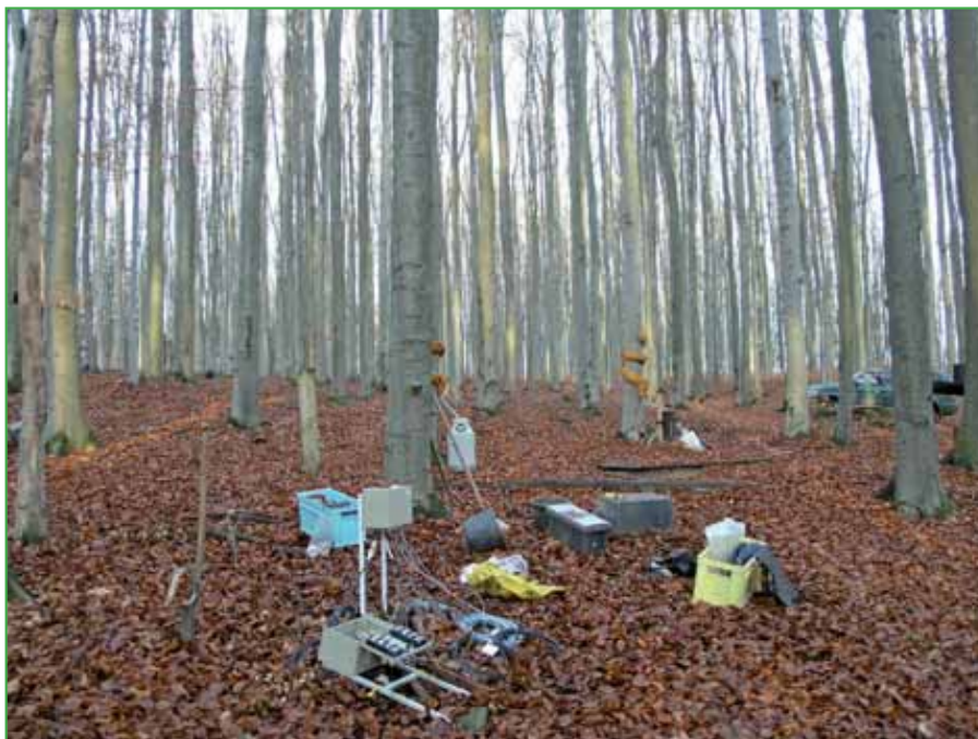
Foto: Instalace půdních čidel Installing soil sensors
