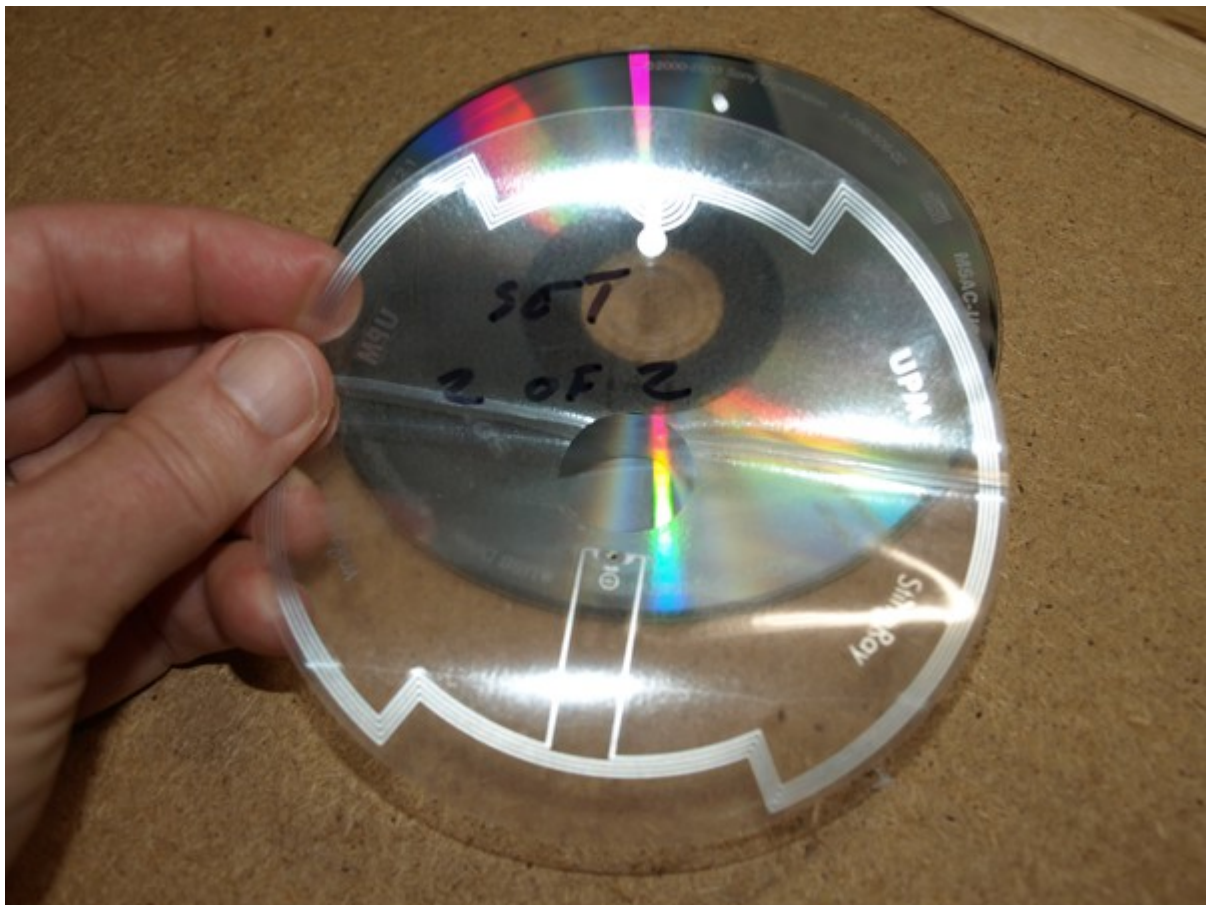
Obr. 8: RFID nálepka pro aplikaci na optický disk.
