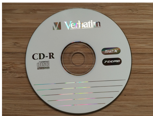
Obr. 2: CD-R – disk, na který lze vypalovat data pomocí CD vypalovací mechaniky.
