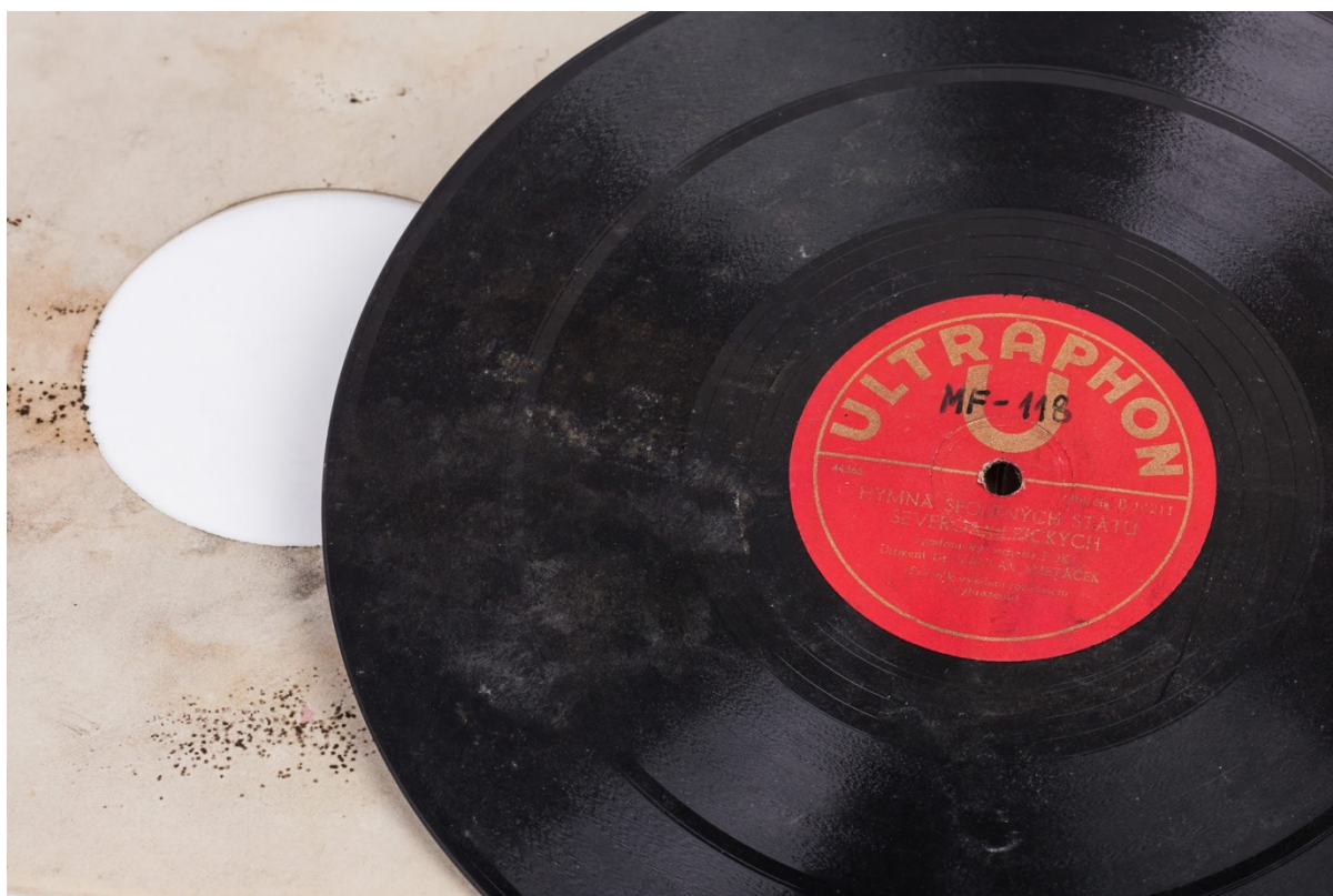
Obr. 10 : Ukázka gramofonové desky a původního obalu napadených plísní
