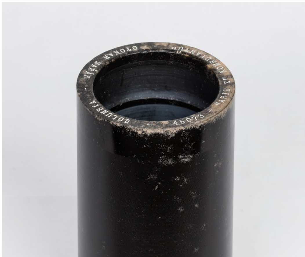
Obr. 11 : Fonografický váleček podléhající degradaci, která připomíná plíseň
