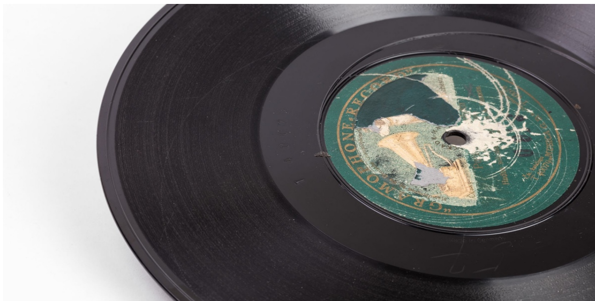
Obr. 12 : Detail škrábání nosiče a etikety jehlou na přehrávání
