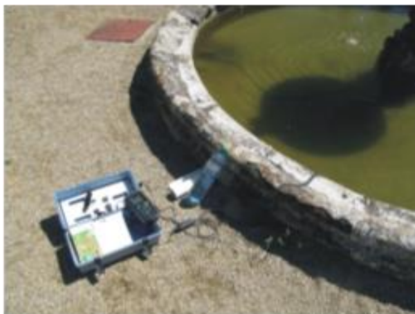
Obr. 2.1 Příklad měření fyzikálně-chemických veličin vody v terénu pomocí přenosného přístroje
