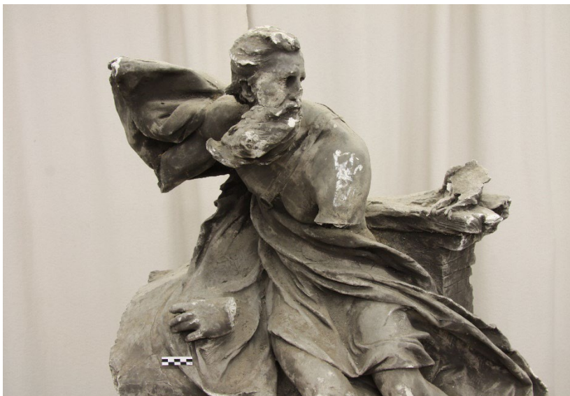
Obr. 4 Sádra není příliš odolná proti otěru a při nevhodné manipulaci snadno dochází k poškození povrchu. Také je velmi křehká a snadno může dojít k odlomení subtilnějších částí.
