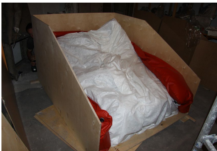
Obr. 15, 16 Příprava plastiky Stanislava Suchardy na transport, dílo je chráněno proti odření bublinkovou folií a geotextilií, volné prostory jsou vyplněny záchrannými vaky z důvodu zajištění díla proti pohybu a roznesení případných vnějších tlaků.
