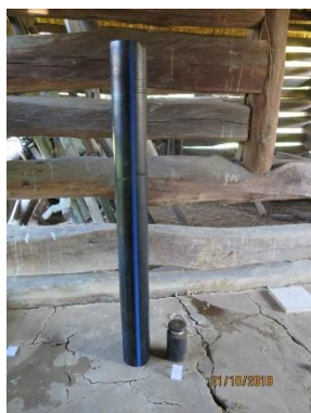
Obr. 17 Zkušební zařízení s vodící trubkou a beranem
