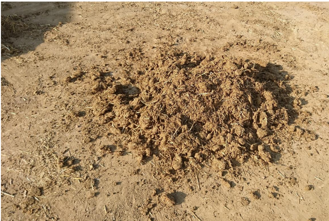
Obr. 5: Promíchaná směs – hotové hliněné těsto
