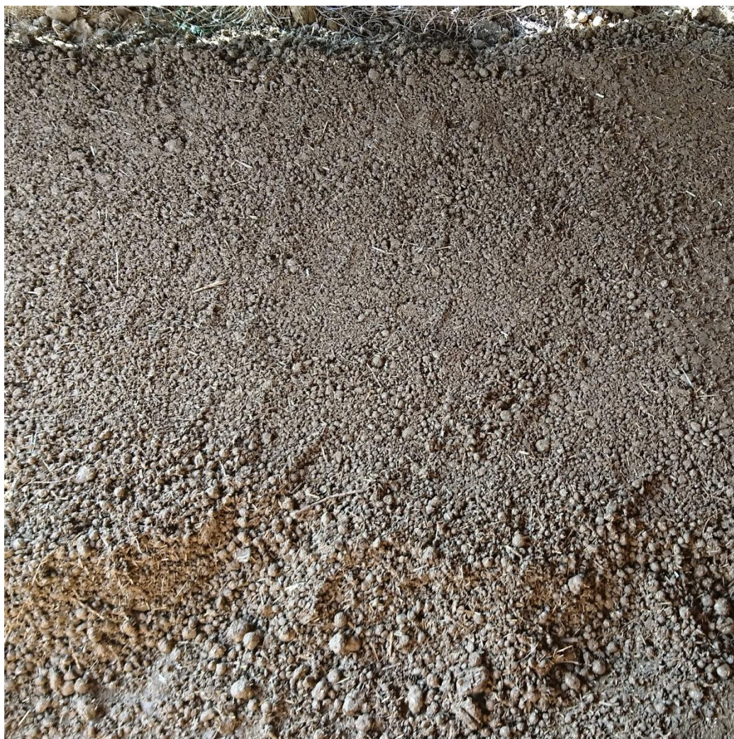
Obr. 6: Ověření zpracovatelnosti hliněného těsta rozprostřením vzorku, o objemu jednoho stavebního kolečka
