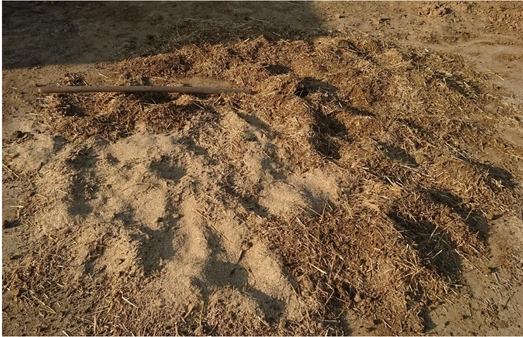
Obr. 4: Částečně promíchaná směs hlíny, řezané slámy a plev na výrobu hliněného těsta
