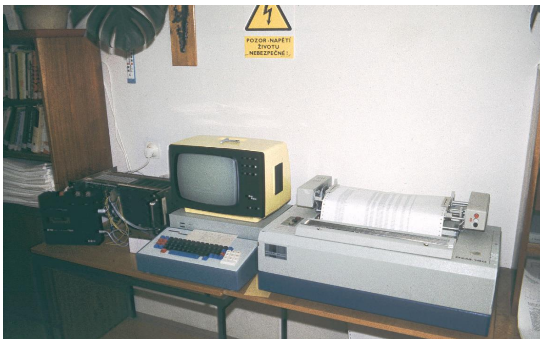
Terminálové pracoviště s počítačem Tesla JPR12, vyvinuté v SVT.
