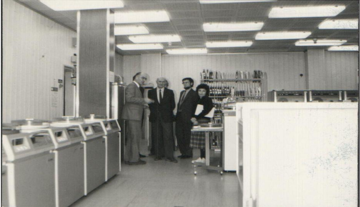
Inspekční návštěva místopředsedy AV Přemysla Ryše na počítačovém sále s počítačem EC 1040 v přístavbě FzÚ v roce 1982. Zleva: Mirko Novák, Přemysl Ryš, Václav Šebesta, Olga Kufudaki. Vlevo jednotky magnetických disků, každý o kapacitě 7,5 MB, vpravo stojany s magnetickými páskami a skříně procesoru.
