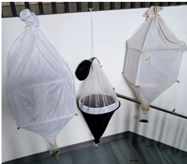
Obr. 1. Příklady tzv. Winklerova eklektoru třech různých kostrukcí. V eklektoru dochází k se-sychání vzorku prosevu a sběru hmyzu do spodní sběrné nádoby s čistým ethanolem.
