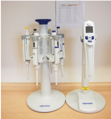
Obr. 4. Vlevo pipety s nastavitelným objemem, vpravo elektronická pipeta.
