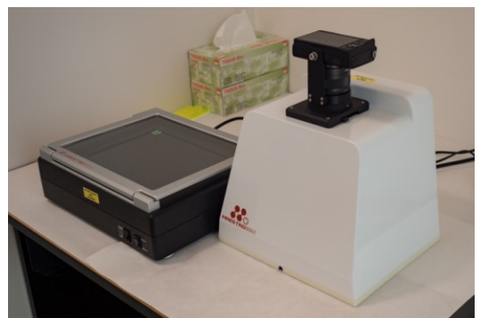
Obr. 9. UV transiluminátor (vlevo) s dokumentačním zařízením (vpravo).
