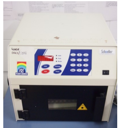
Obr. 13. UV crosslinker na sterilizaci spotřebního materiálu pod UV světlem.
